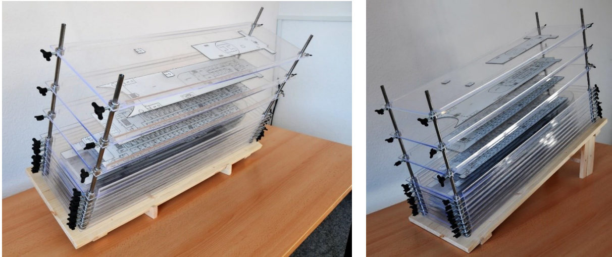
Abbildung 8: Umsetzung von Krängung bzw. Trimm am Decksmodell
