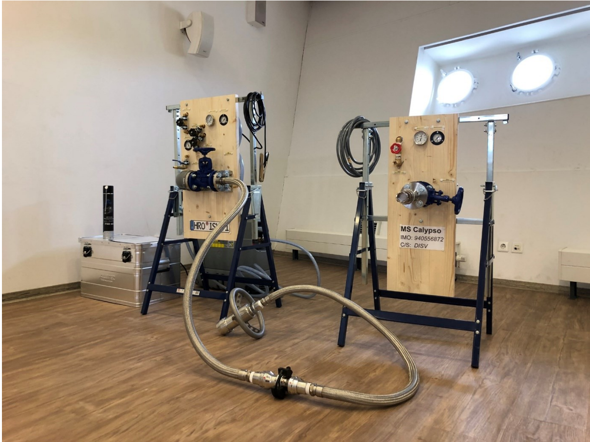
Abbildung 10: LNG-Bunker-Simulator, links: Anschlussstation des Trucks, rechts: Anschlussstation des Schiffes, Kopplungsschlauch, im Hintergrund Kompressor
