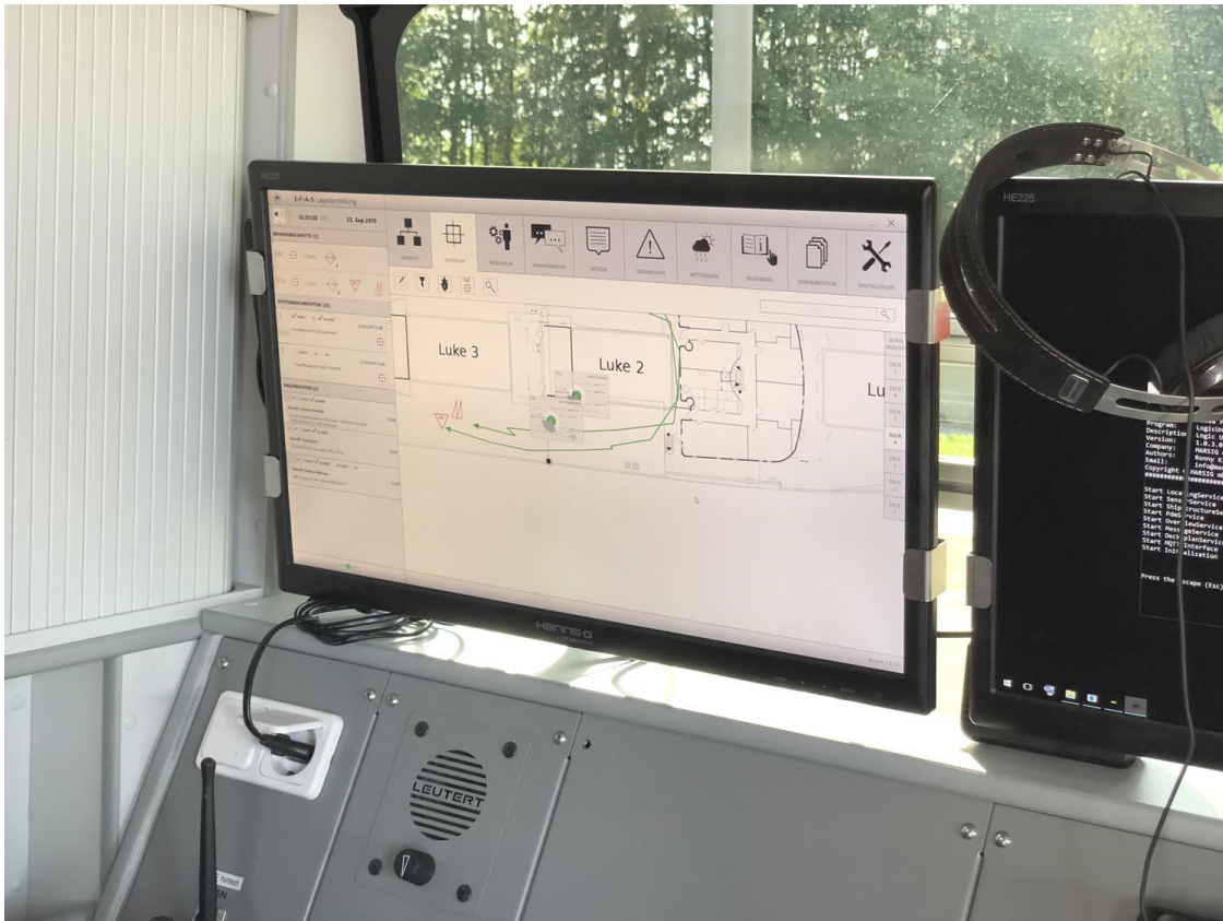
Abbildung 15: Blick in den Einsatzleitwagen, ausgerüstet mit dem im Projekt durch die Partner entwickelten Lagebild- / Ortungssystem
