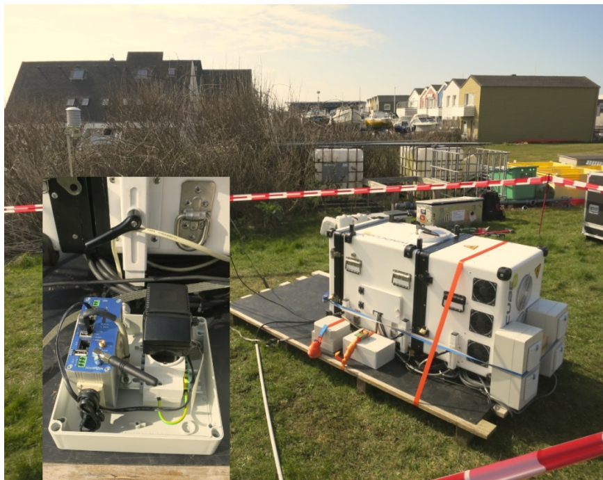
Abbildung 18: Wind-LIDAR am Standort Helgoland (Gelände des Alfred-Wegener-Institut, Hafengebiete), links im Detail das Industriemodem zur Datenübertragung
