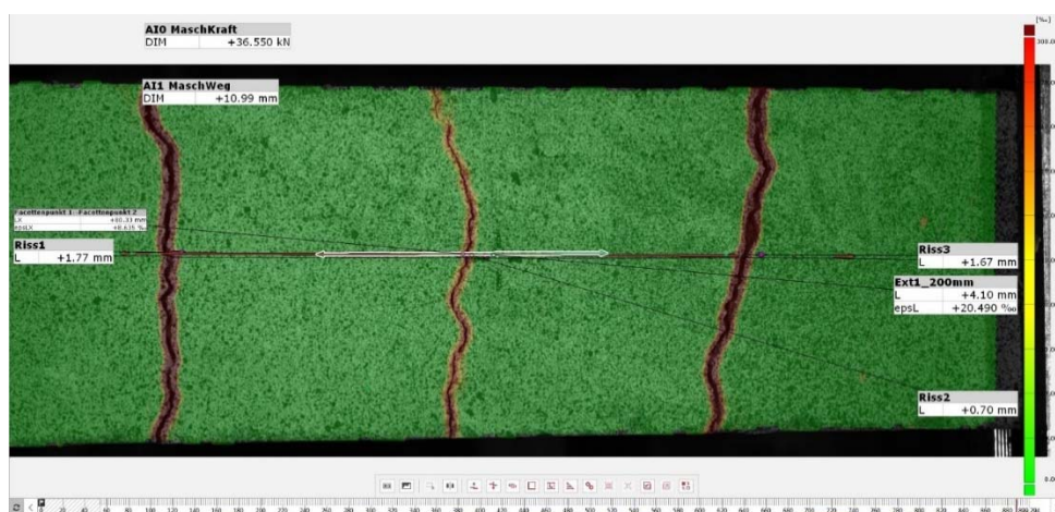
Abbildung 22: Beispielhaftes Photogrammetrie-Bild in ARAMIS® auf Dehnkörpern
