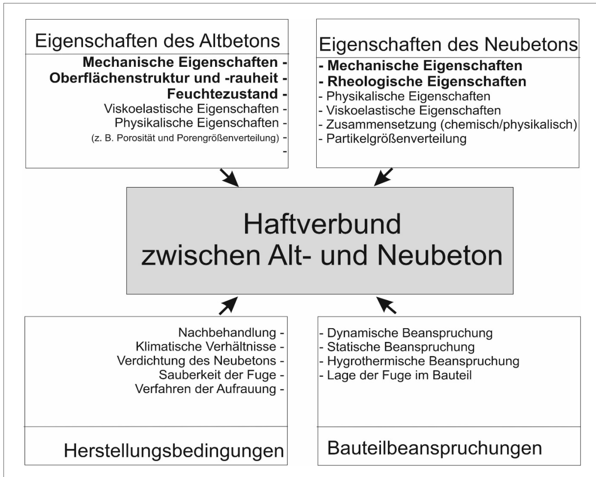
Abbildung 7: Schematische Darstellung wichtiger Einflussgrößen für den Haftverbund [16]
