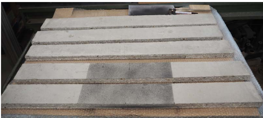
Abbildung 21: Photogrammetriemuster auf Dehnkörpern
