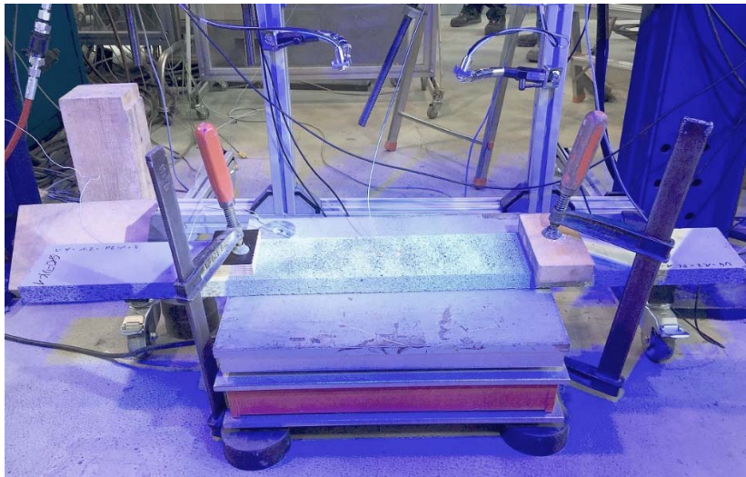
Abbildung 35: Versuchsaufbau 3: Auf Heizplatte eingespannter Probekörper
