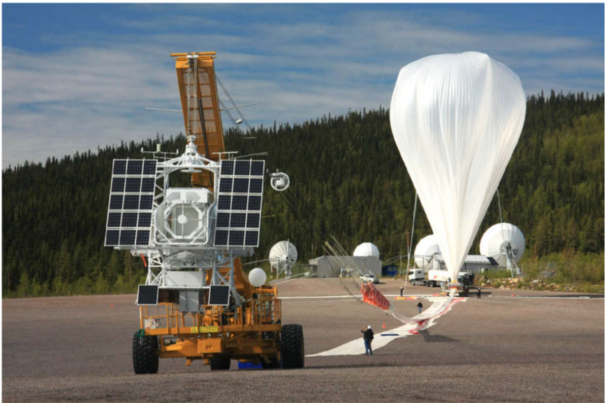
Abbildung 8: Sunrise kurz vor dem Start. Der Ballon ist am Boden nur zum Teil mit Helium gefüllt, um sich während des Aufstieges bei abnehmendem Druck ausdehnen zu können. Bei einer Höhe von 37km wird der Ballon sich um das 300-fache vergrößert haben. Auch bei dieser Mission verbindet ein Fallschirm den Ballon mit der Sonde. (Barthol et al., 2011).
