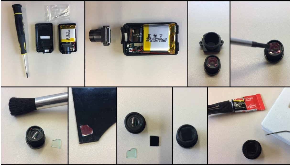
Abbildung 19: Umbau einer Mobius Action Cam zur NIR-Kamera. Der IR-Sperrfilter wird ersetzt durch Material, welches kein sichtbares Licht aber Infrarotstrahlung hindurchlässt.
