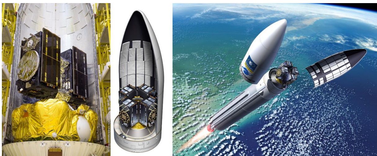
Abbildung 8: Paarweiser Transport der Galileo-FOC Satelliten mittels einer Sojus-Rakete (links). Seit dem sechsten Start der FOC-Phase erfolgt der Transport mit einer Ariane 5 SE VA233 von je vier Satelliten (Mitte, rechts) (links: ESA 2015, Mitte ESA 2017 b, rechts: ESA 2017 c).
