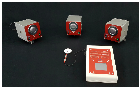
Abbildung 4: Das NaviSat System besteht im Wesentlichen aus drei Sendern (Satelliten) und einer zentralen multifunktionalen Kontrollstation
