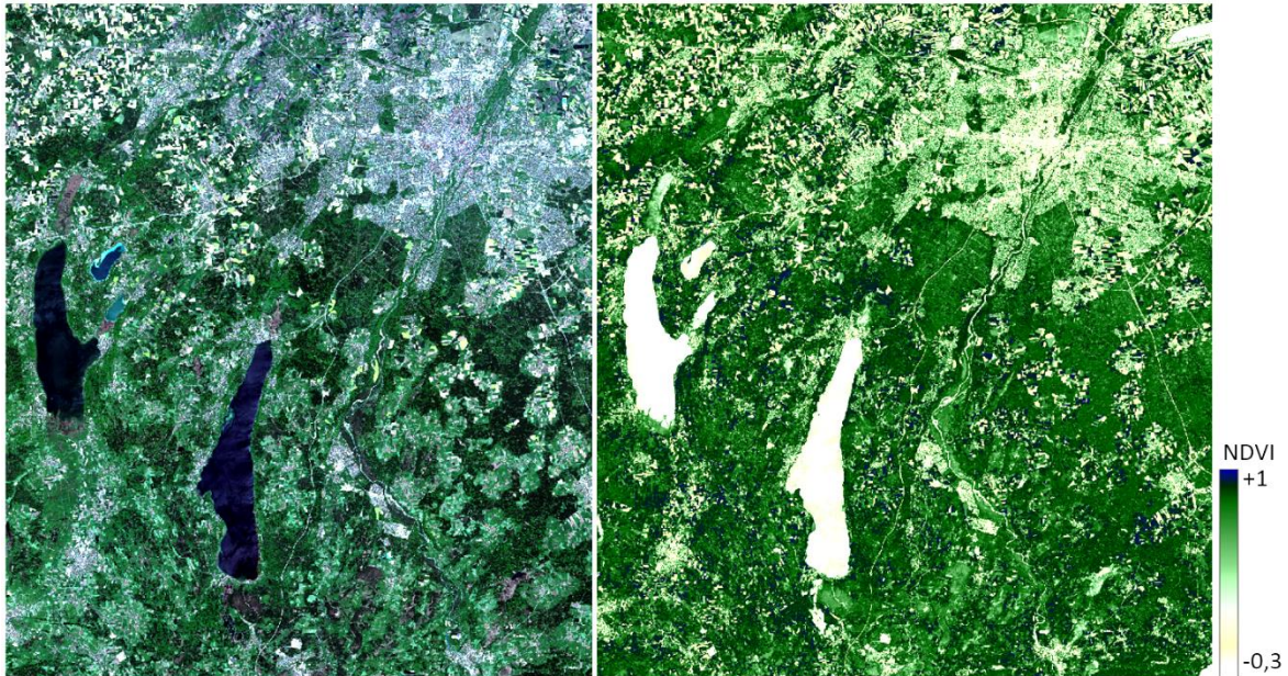
Abbildung 26: NDVI-Falschfarbenbild (rechts) basierend auf einer Sentinel-2-Szene vom 17.05.2017 südwestlich von München (RGB-Darstellung links). Hohe NDVI-Werte werden meist mit einem grünen Farbverlauf dargestellt. Vegetationslose Flächen werden üblicherweise in brauner oder weißer (NDVI<0) Farbe dargestellt (Datengrundlage: Sentinel-2, ESA 2017).
