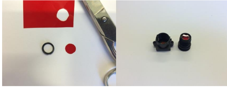
Abbildung 9: Der IR-Sperrfilter wird durch ein Stück roter Filterfolie ersetzt.
