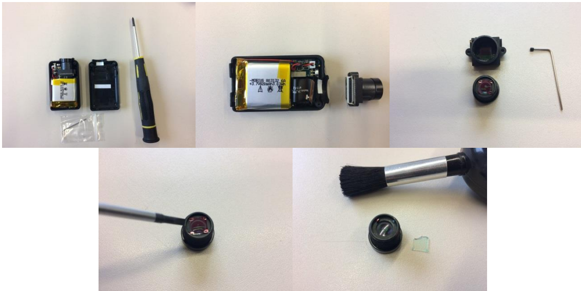
Abbildung 8: Umbau einer einfachen Digitalkamera zur NDVI-Kamera. Zuerst wird der eingebaute IR-Sperrfilter entfernt.
