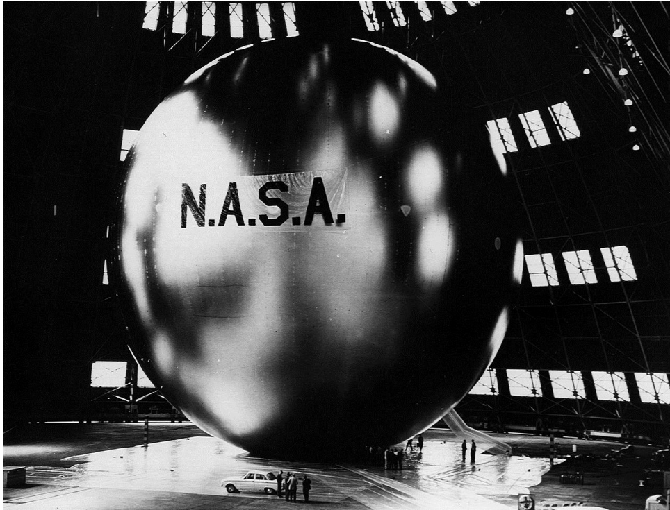
Abbildung 1: Ein Ballon als Vorgänger passiver Nachrichtensatelliten: Echo-1 der NASA. Der mit Aluminium beschichtete Ballon reflektierte das von einer Bodenstation gesendete Signal über große Distanzen weiter.
