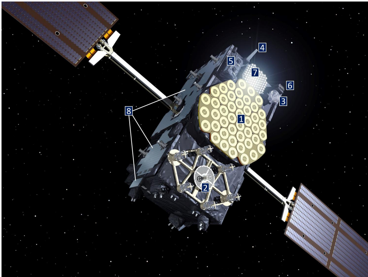
Abbildung 12: Anatomie eines Navigationssatelliten mit den Subsystemen 1) L-Band-Antenne; 2) Such- und Rettungsantenne; 3) C-Band-Antenne; 4) S-Band-Antenne; 5) Infrarot-Erdsensor; 6) Sonnensensor; 7) Laser-Reflektor; 8) Weltraum-Radiatoren (verändert nach ESA 2011).
