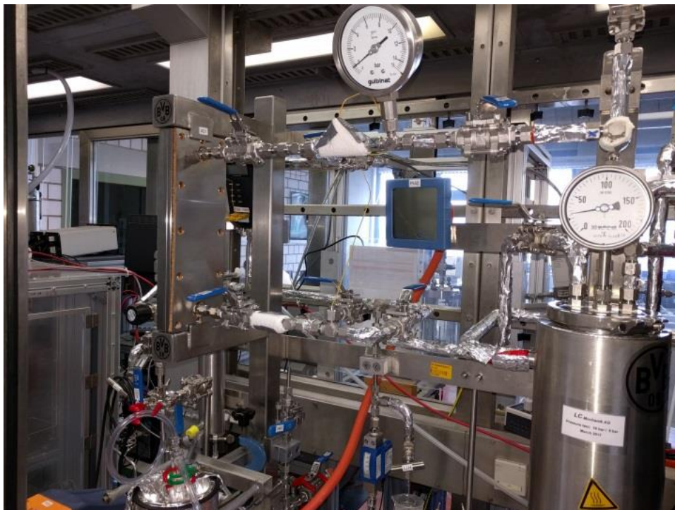
Abbildung 30: Membranversuchsanlage für die Durchführung von Pervaporationsversuchen.
