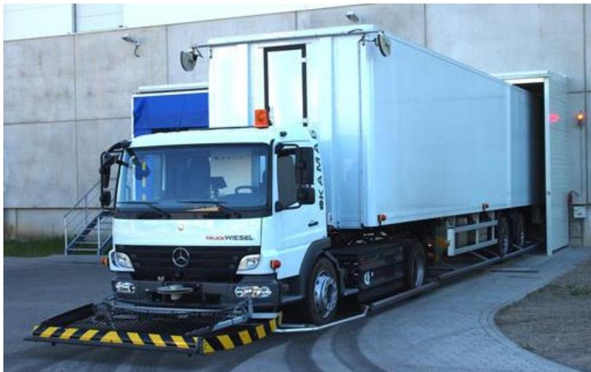
Bild 2: Outdoor-FTF nach dem Stand der Technik zu Projektbeginn (Quelle: Götting KG)
