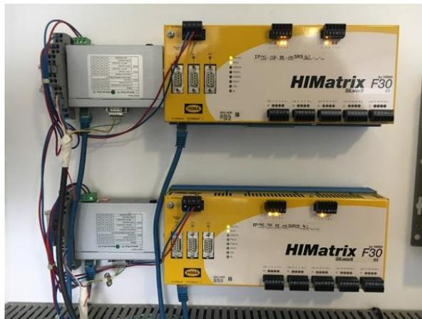
Bild 6: Auswerteeinheiten für die Bodenscanner im Fahrzeug
