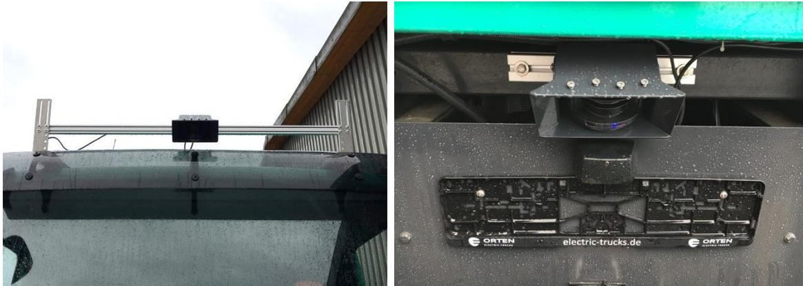
Bild 5: Bodenscanner vorne (links) und hinten (rechts) mit kleiner Wetterschutzhaube
