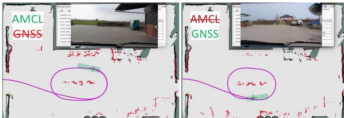
Bild 8: Tests zum Wegfall GNSS (links) und AMCL (rechts)
