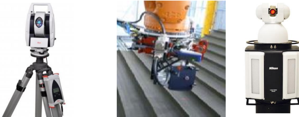
Abbildung 78: Messsysteme für die Spantmontage und Spaltanalyse
