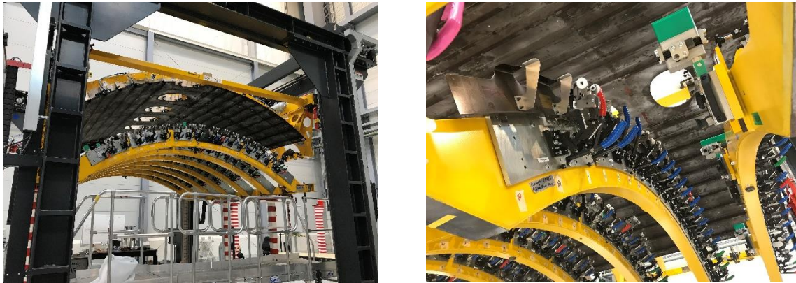
Abbildung 82: Spant in der Montageanlage eingesetzt
