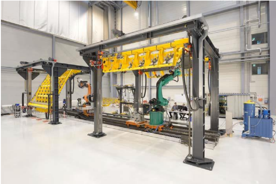
Abbildung 8: Großanlage zum teilautomatisierten Einrüsten von Kleinbauteilen in Hautfelder des CFK-Rumpfes der ersten Generation
