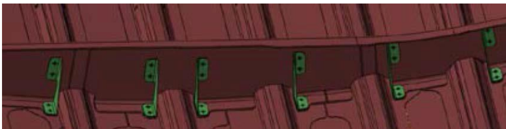
Abbildung 36: Symmetrische Anordnung der Cleattypen (in grün dargestellt) am Integralspant
