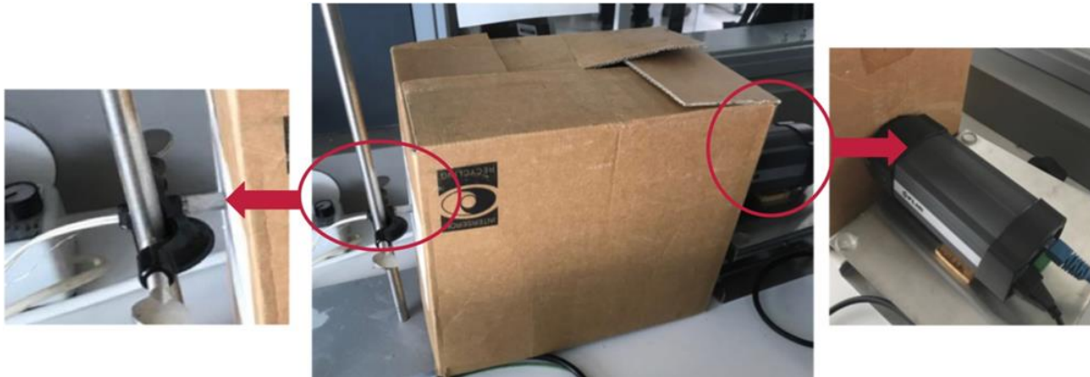
Abbildung 10: Set-Up zum Erzeugen und Detektieren von Hotspots: Heizstab (links), Wärmebildkamera (rechts)
