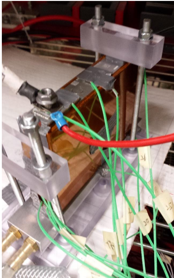
Abbildung 4: Versuchsaufbau zur Detektion der Temperaturverteilung über einer Batteriezelle mittels diverser Thermoelemente. Die Kühlung über eine mit Wasser-Glykol durchströmte Bodenplatte und durch freie Konvektion an den zur Umgebung in Kontakt liegenden Oberflächen.
