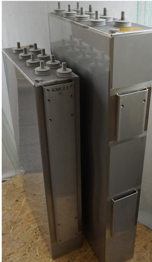
Abbildung 69: Größenvergleich Demonstrator (links) mit konventionell gefertigtem Kondensator (rechts) für MMC
