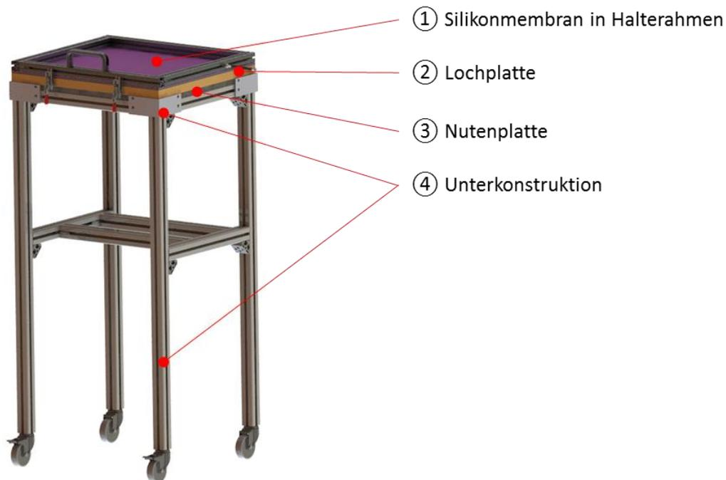
**Abbildung 2 Übersicht Vakuumtisch**
