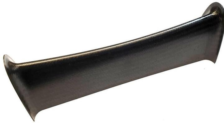
**Abbildung 29 Preformling aus dem Presswerkzeug**
