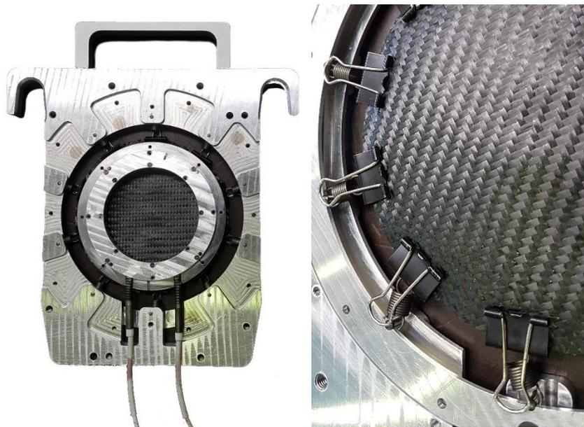
**Abbildung 17 Spannrahmen mit Prepreg**
