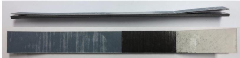
**Abbildung 9: Delamination einer CC-Ta-CC Probe nach der Herstellung**
