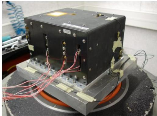
**Bild 2: Prüfling montiert auf dem ‚Shaker‘ (hier Z-Achse)**
