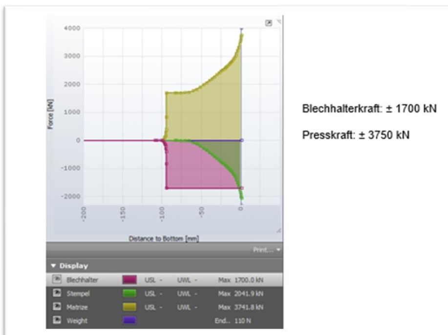
Bild II.2-11: Finale Ziehanlage: Presskraft simuliert
