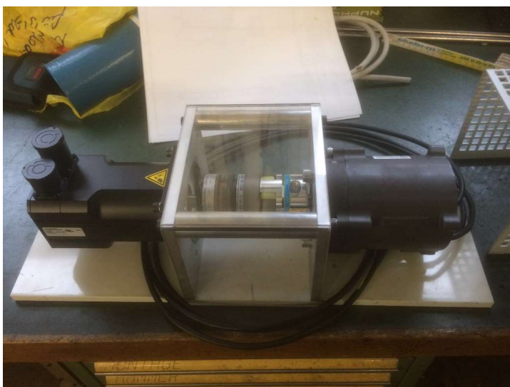
Abb. 4: Aufbau Versuchsstand (rechts Kfz.- Lenkmotor der Fa. Hella)
