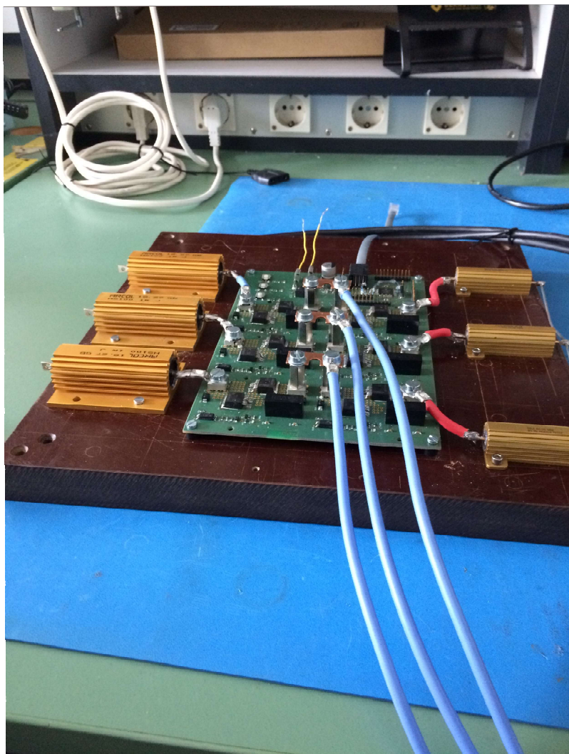
Abb. 15: Umschalteinheit im Testbetrieb EMFT
