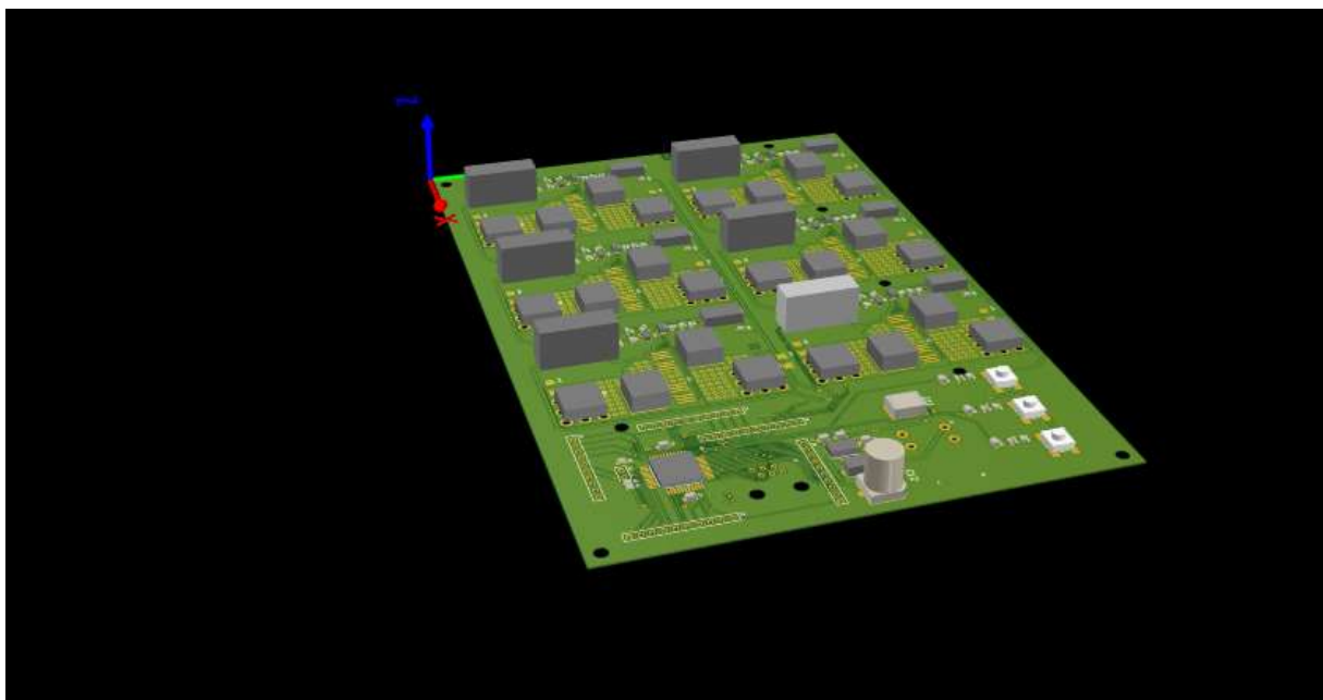
Abb. 14: 3-D Darstellung des Umschalters
