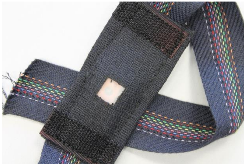
Abbildung: Ein Sensor nach 5 Minuten bei 180°C
