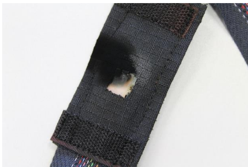
Abbildung: Ein ausgefallener Sensor nach 10 Sekunden direkter Beflammung
