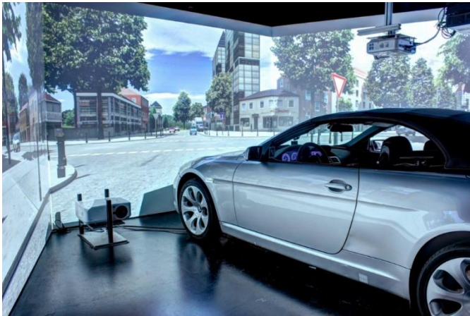
Abbildung 4: Statischer Fahr Simulator des Lehrstuhls für Ergonomie der TU München (Bildquelle: TUM 2020).
