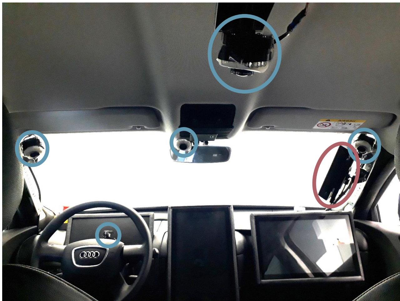
Abbildung 3: Übersicht des im Fahrsimulator verbauten Gesamtsystems mit allen Kameras. NIR-Kameras in blau. Kinect V2-Tiefenkamera in rot.
