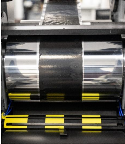
Abbildung 86: Entwickelter Prozess zur Kalandrierung und direkten Laminierung
