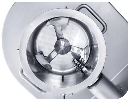
Abbildung 12: links: Lödige Pflugscharmischer, rechts: hergestellte Granulate aus Lödige Mischer
