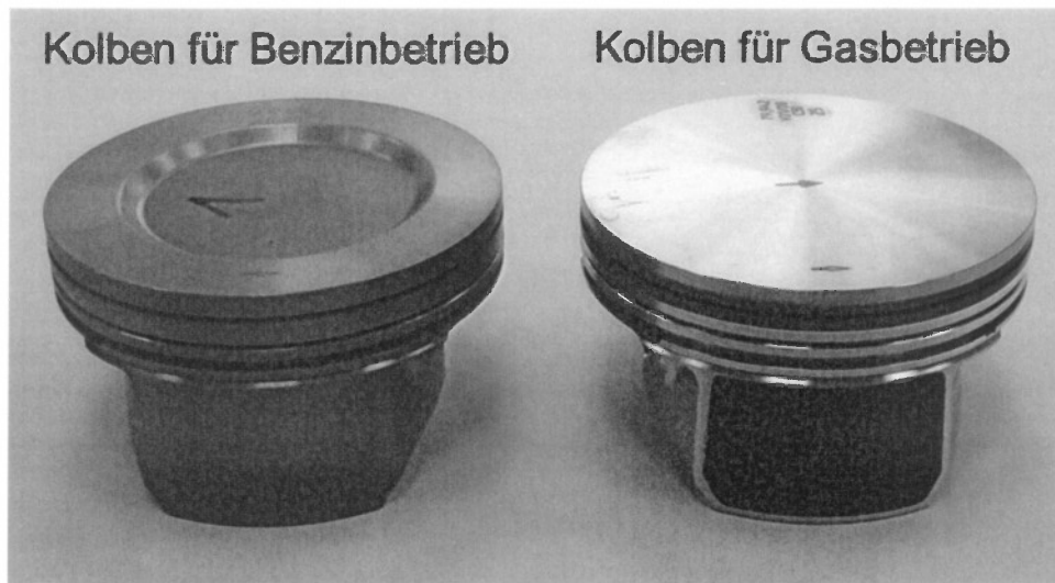
Abbildung 7: Kolben für Benzin- und Gasbetrieb
