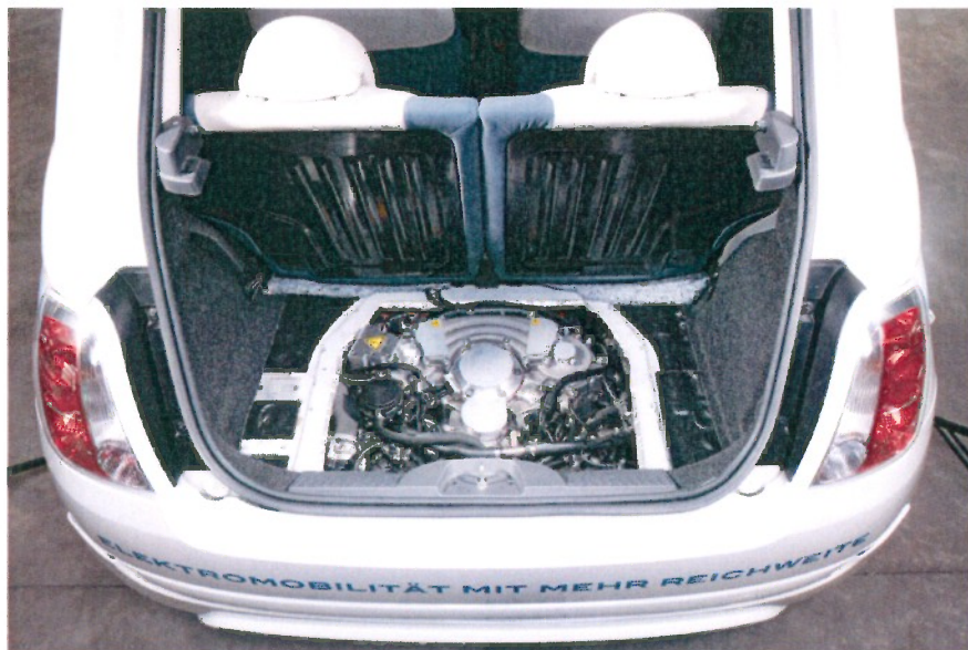
Abbildung 6: Demonstratorfahrzeug mit Unterflureinbau des RHA-Range-Extenders
