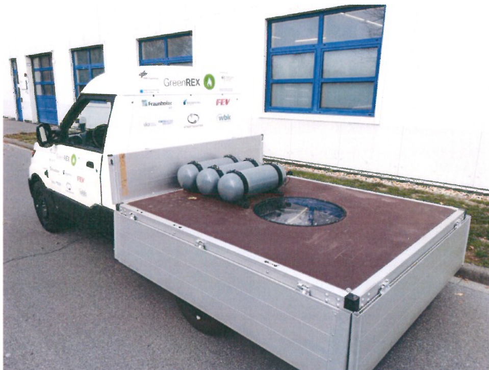
Abbildung 8: Demonstratorfahrzeug nach Umbau auf Gasbetrieb
