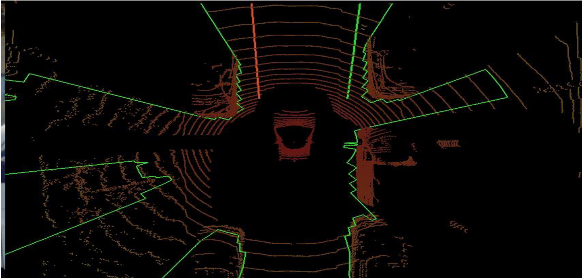
Abbildung 2-8: Der aus den 32-Strahl-LiDAR Daten mittels optimierten Algorithmus erkannte, absolute Freiraum (grüne Polygonlinie).
