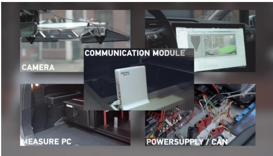
Abbildung 2-18: Systemkomponenten HELLA Aglaia
