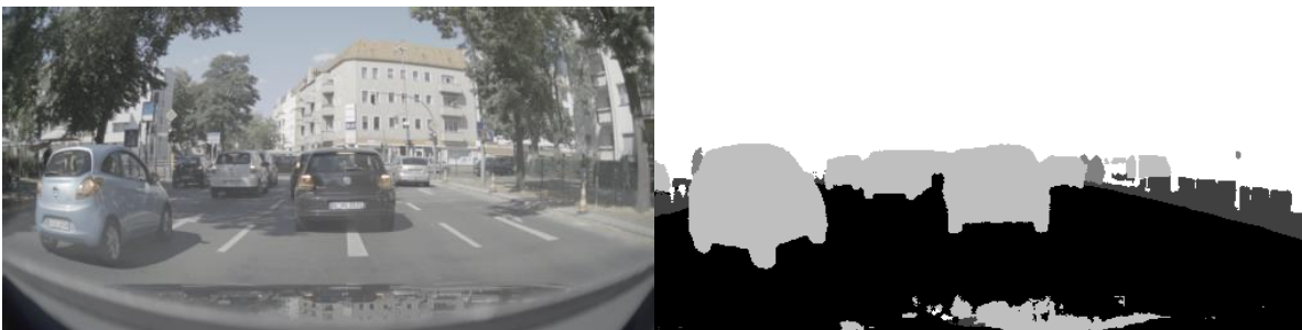
Abbildung 2-3: Aufnahme aus dem Versuchsgebiet. Links: Originalbild, Rechts: Ergebnis aus der semantischen Segmentierung
