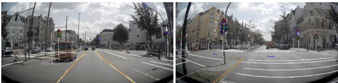
Abbildung 2-14: Links: inkorrekte Lokalisierung, Rechts: korrekte Lokalisierung. Anhand der rückprojizierten Kartenelemente (Fahrbahnmarkierungen, Ampeln und Schilder) kann ein menschlicher Auswerter beurteilen, ob diese korrekt über den im Bild sichtbaren Elementen liegen.
