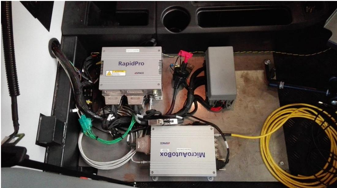
**Abbildung 12: RCP Steuerung des Range Extenders im Fahrgastinnenraum**
