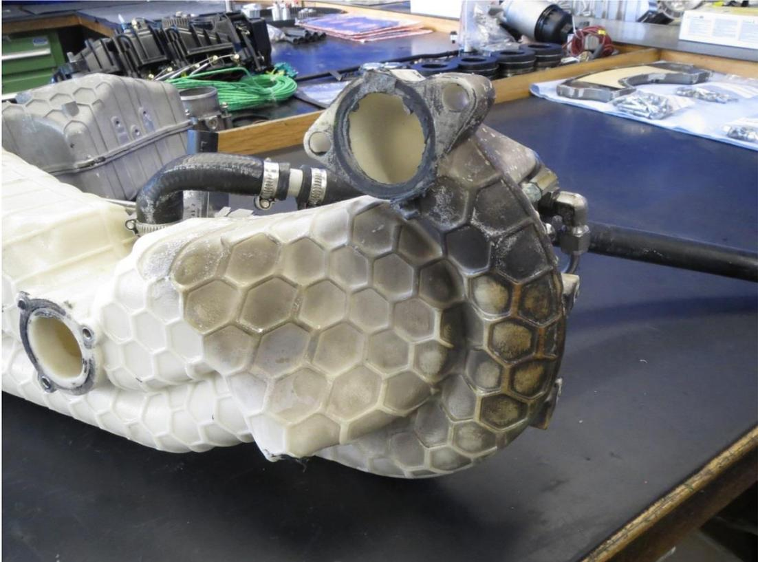
**Abbildung 20: Brandschaden Saugrohr**
