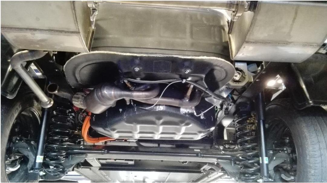
**Abbildung 8: Kapselung Range Extender Modul „Bottom“**
