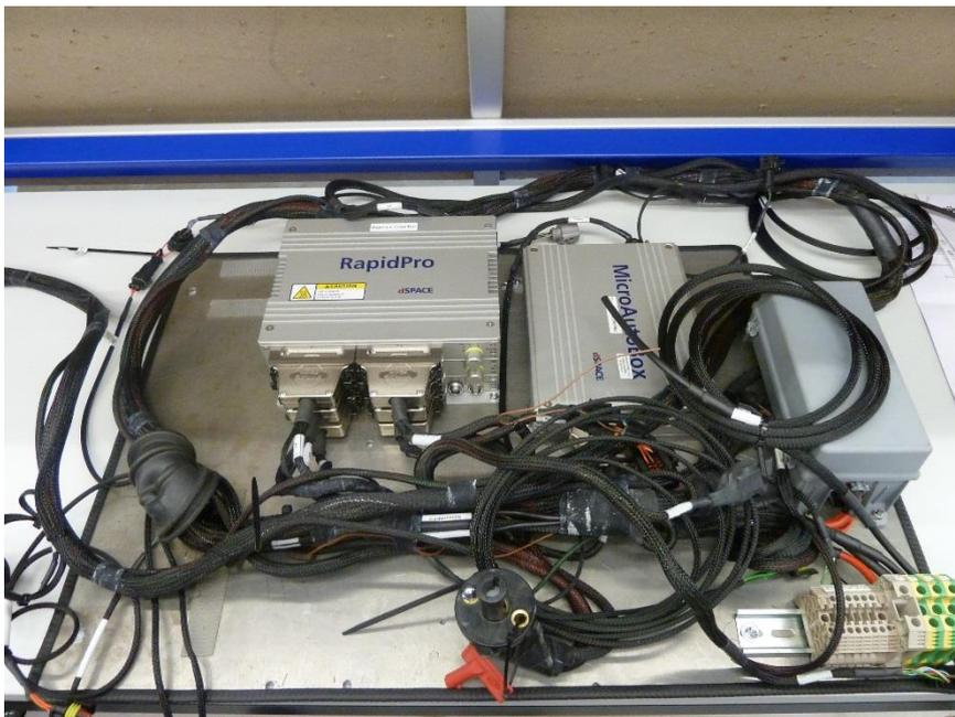
Abbildung 17: RCP Steuereinheit und Kabelbaum
