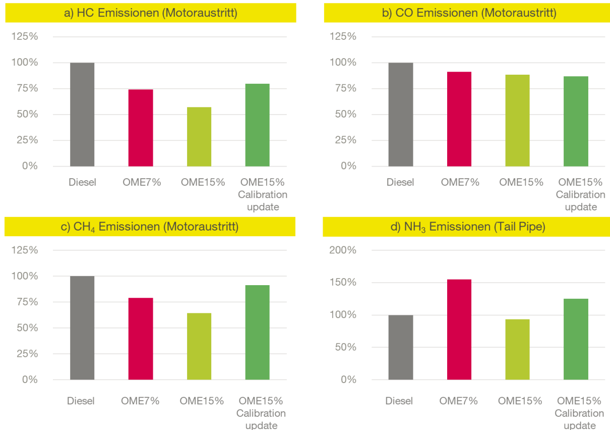
Abbildung 20: HC, CO, CH 4 und NH 3 Emissionen für WLTC Test am Motorprüfstand für die Kraftstoffe Diesel, OME7% und OME15%, alle mit Seriensatz gefahren, OME15% noch zusätzlich mit angepasstem Datensatz; Messung am Motorausstritt
