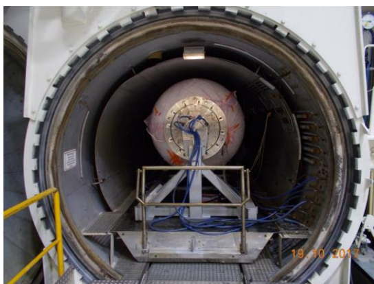
Aushärtung im Autoclave
