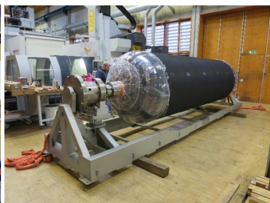
Entfernen des Vakuumaufbaus
