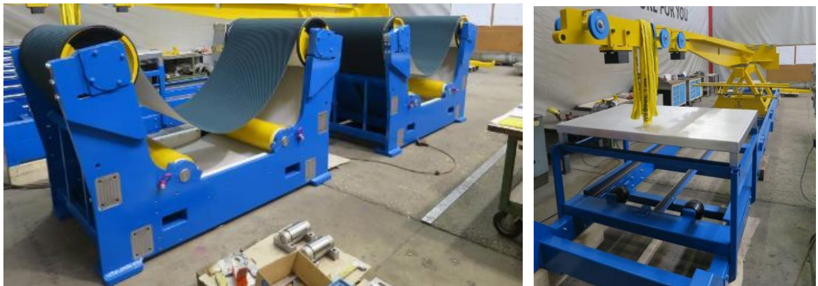
Abbildung 3-12: Bandförderer und Demontageeinheit
