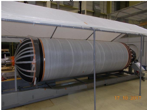
EPDM Bewicklung auf dem Zylinderbereich
