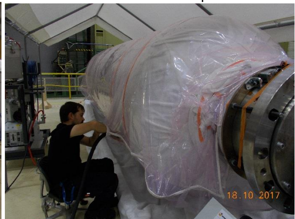
Vakuumaufbau zur Aushärtung
