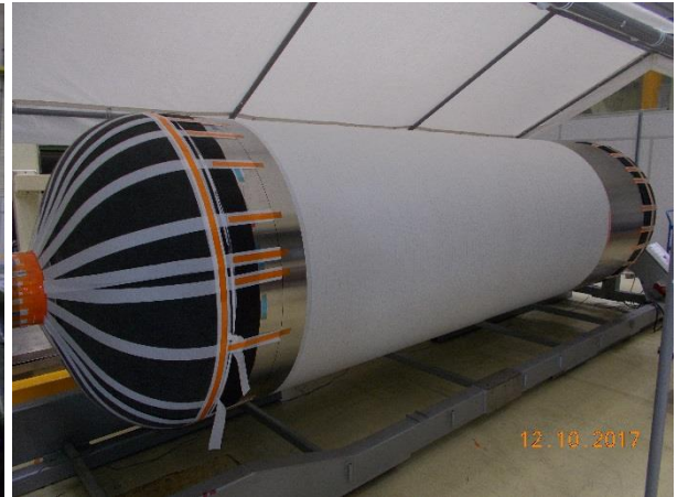
Dom fixiert auf Wickelkörper
