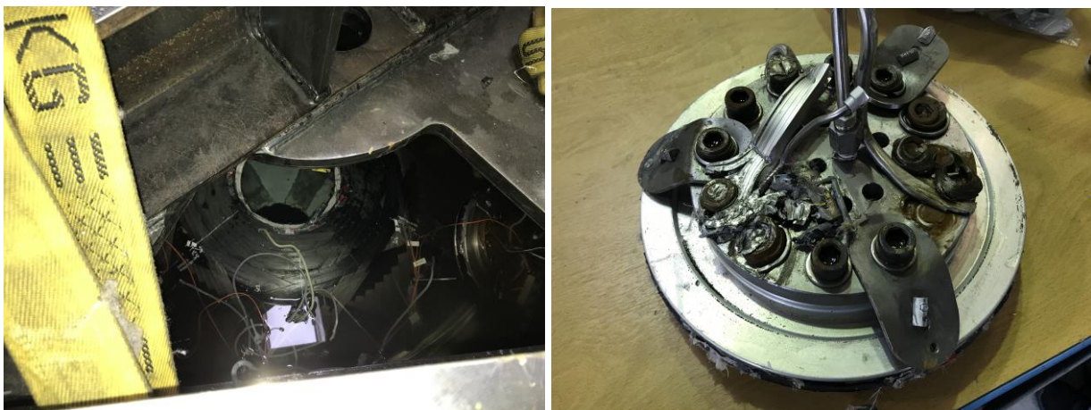
Abbildung 3-9: Versagen am Zünderdeckel
