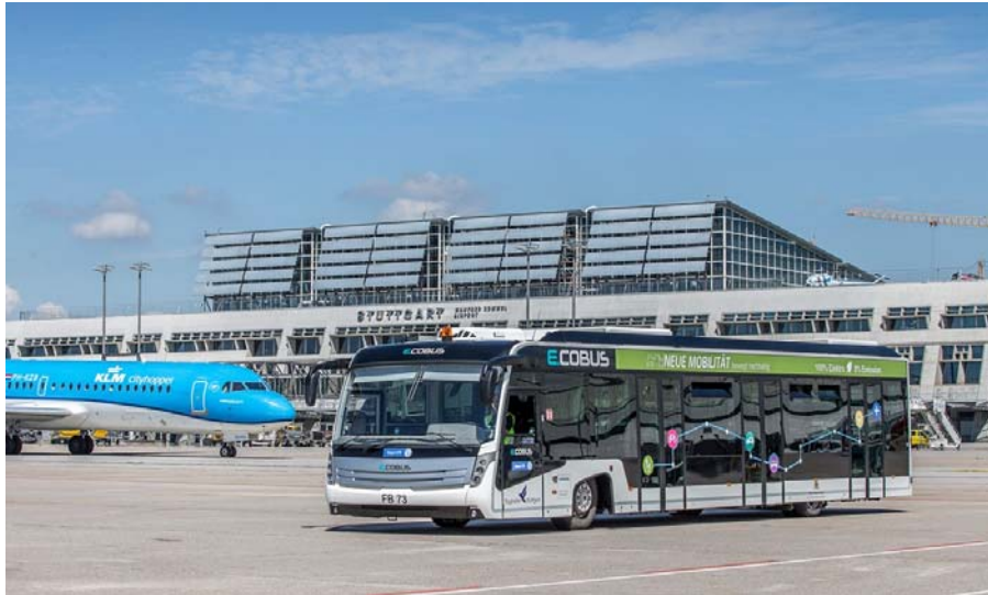
Abbildung 3-3: El. Passagierbus mit Li-Ion Batterie, Typ: eCobus 300, Fa. Cobus Industries GmbH
