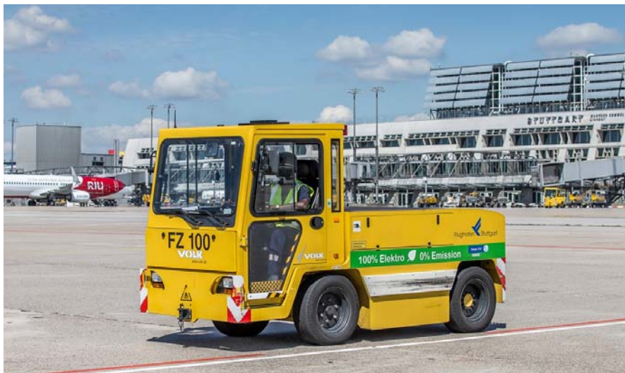
Abbildung 3-4: El. Vorfeldschlepper, Typ: NT30 LR, Fa. Volk Fahrzeugbau GmbH
