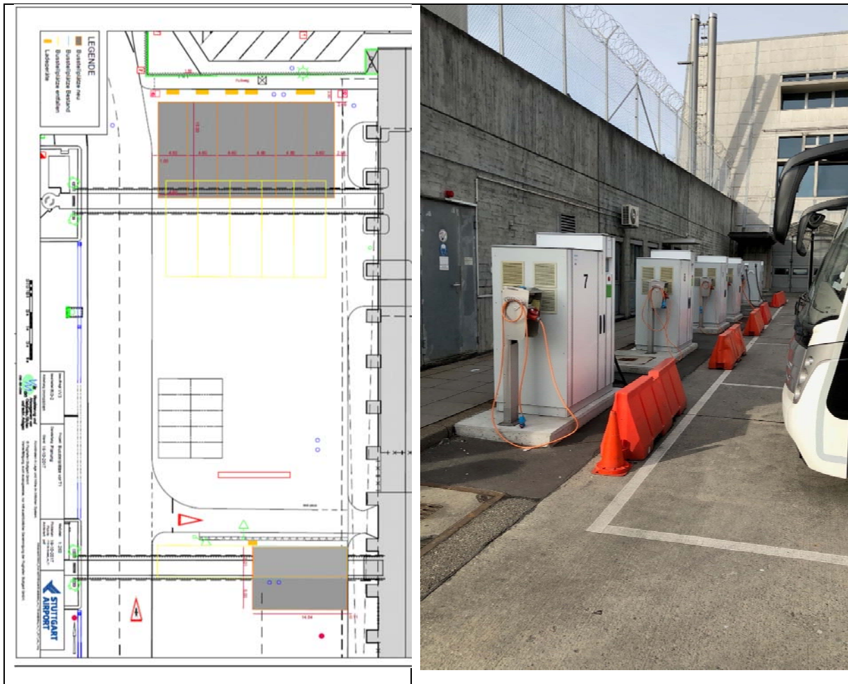
Abbildung 3-19: Aufbau der Busladeinfrastruktur am Terminal 1
