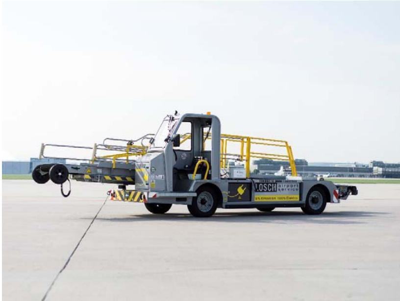
Abbildung 3-15: EI. Förderband, Typ: NBL ELECTRIC, TLD Europe
