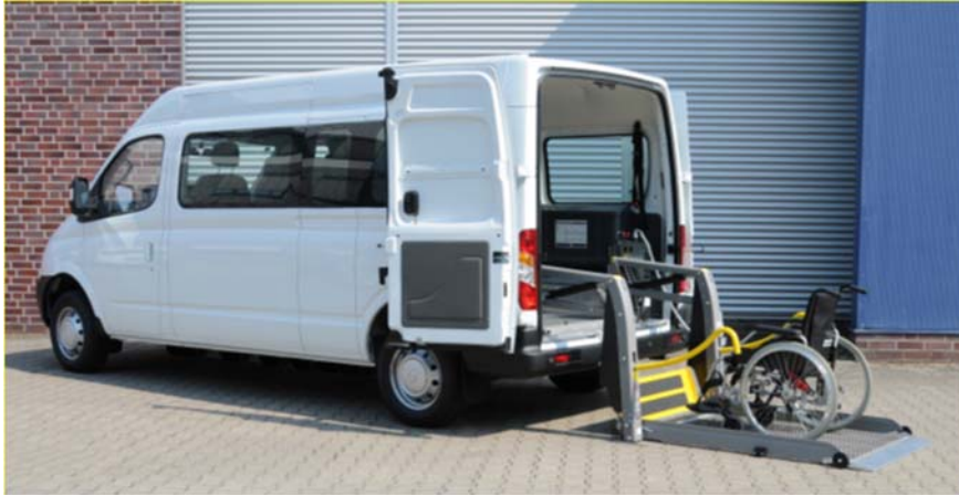
Abbildung 3-11: Testeinsatz am Flughafen Stuttgart: Behindertentransporter mit Li-Ionen-Technologie, Typ Maxus EV80, Fa. SAIC Mobility Europe
