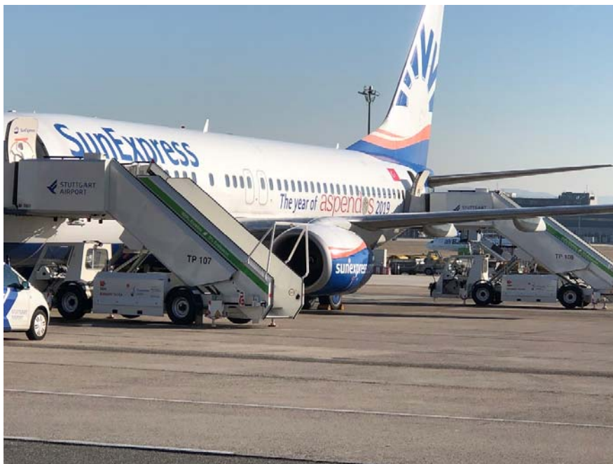
Abbildung 3-6: EI. Passagiertreppen mit Li-Ion Batterie, Typ RUNWAY1842, Fa. Tips
