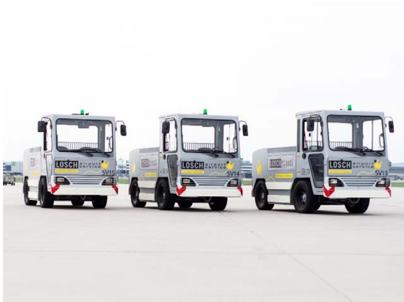
Abbildung 3-14: EI. Vorfeldschlepper, Typ: EFZ 30 NT LR LR, Fa. Volk Fahrzeugbau GmbH
