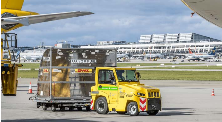
Abbildung 3-7: Frachtschlepper mit Li-Ionen-Technologie, Typ: Sherpa E, Fa. Goldhofer AG
