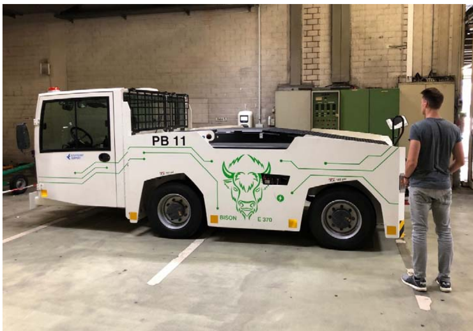
Abbildung 3-10: Testeinsatz am Flughafen Stuttgart: Push back Schlepper mit Li-Ionen-Technologie, Typ Bison 370, Goldhofer AG
