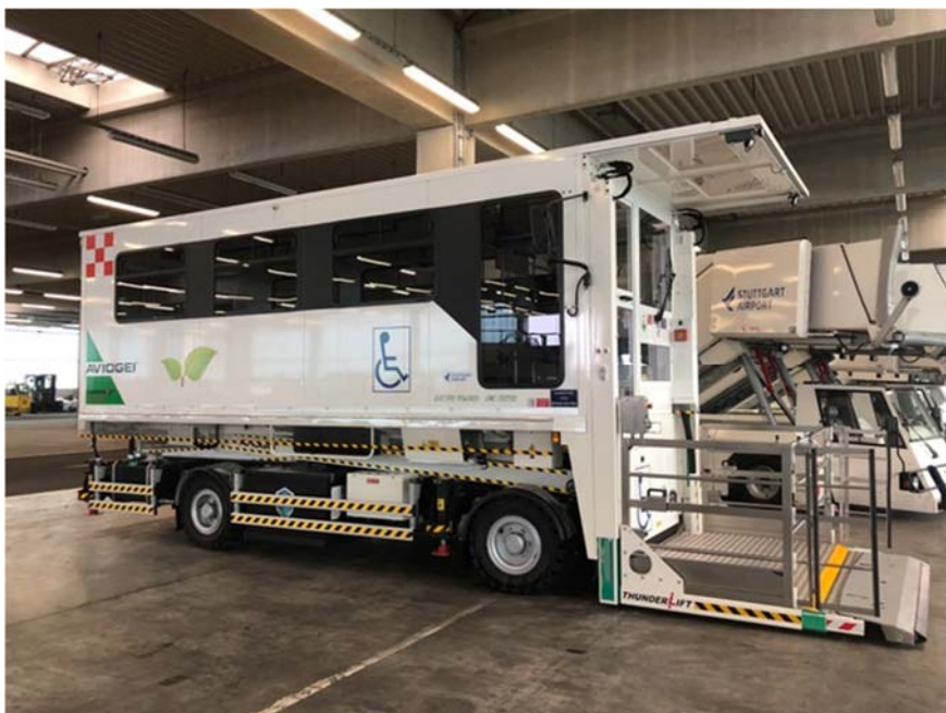
Abbildung 3-12: Testeinsatz am Flughafen Stuttgart: Behindertentransporter, Typ: Thunderlift, Aviogei SSA
