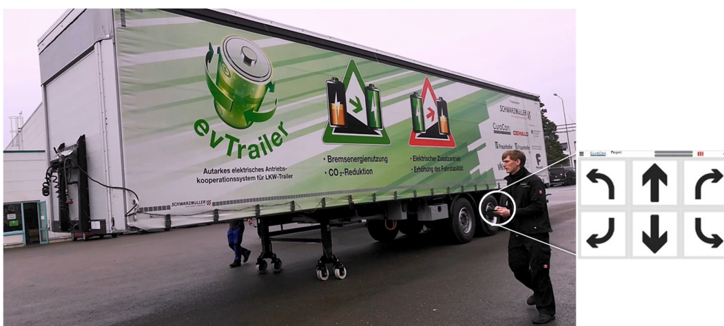
Bild 18: Autarkes Rangieren ohne Zugmaschine
