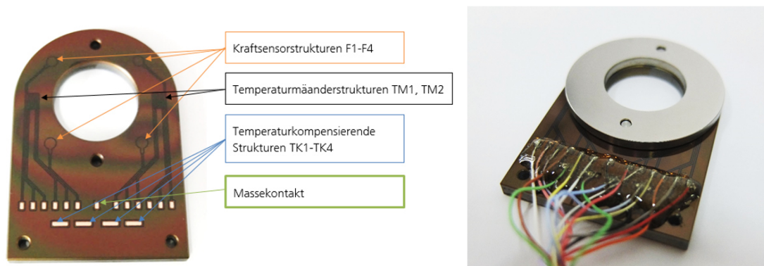
Bild 27: Sensorisches Unterlegscheibensystem links mit Beschreibung der einzelnen Strukturen und rechts vollständig aufgebaut.
