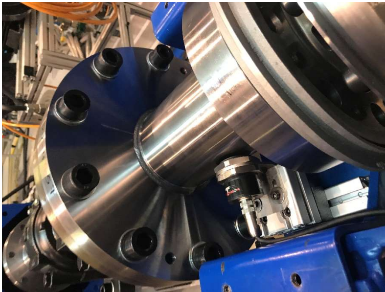
Abbildung 6: Hohlwelle mit Drehmomentensensor
