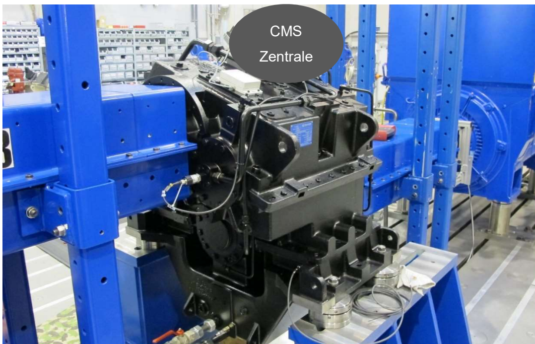
Abbildung 5: CoMoGear CMS im Versuchsgetriebe eingebaut
