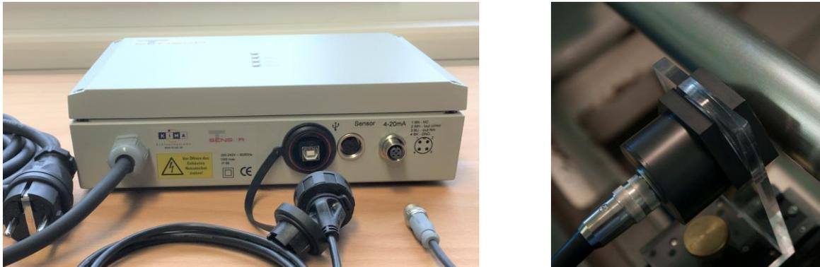
**Abbildung 10: Prototyp des Drehmomentmesssystems der Fa. HZDR Innovation GmbH, links: Signalkonditionierung und Spannungsversorgung, rechts: Sensorkopf vor der zu messenden Welle**
