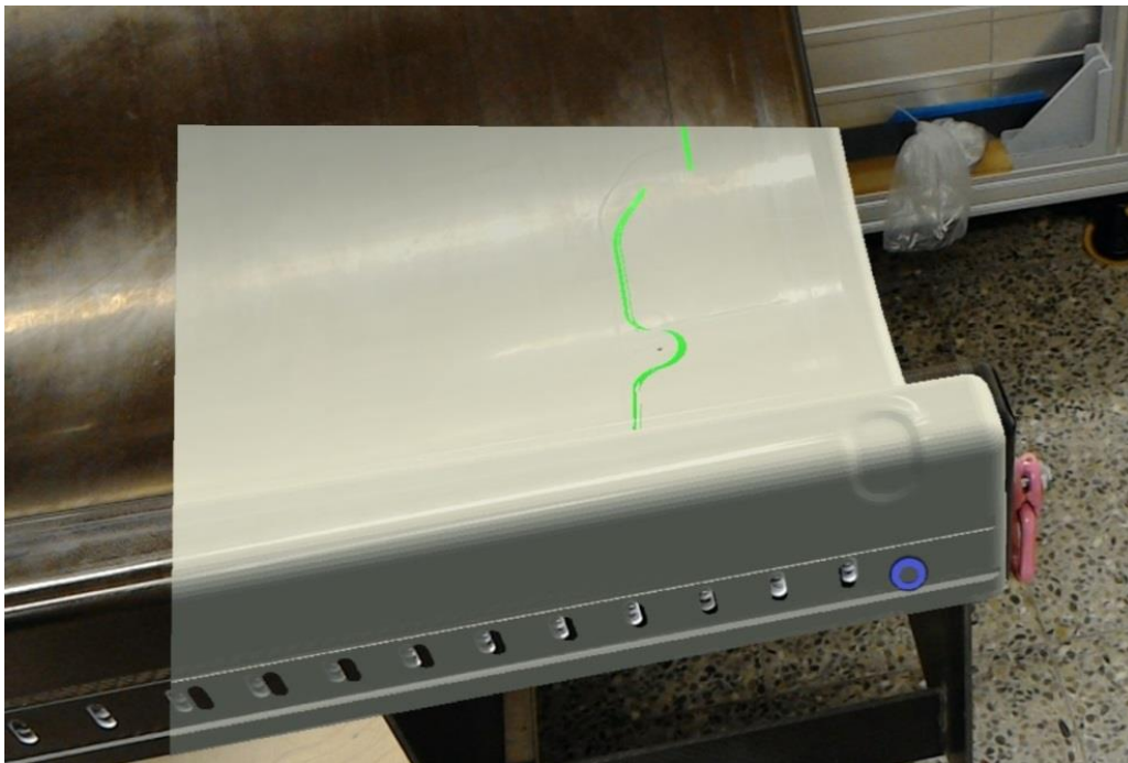
Abbildung 37: Die virtuelle grüne Linie zeigt einen Versatz zur realen Kontur auf dem Formwerkzeug; Ansatz mit konventionellem Bildmarker von PTC Vuforia
