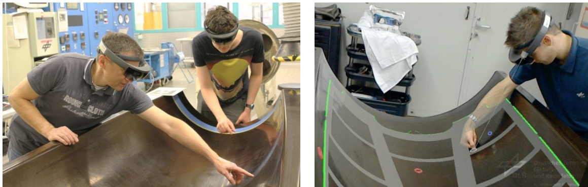
Abbildung 14: Erste Versuch zu kooperativen Arbeiten mit der HoloLens und der Projektion von Details auf der Werkzeuoberfläche.
