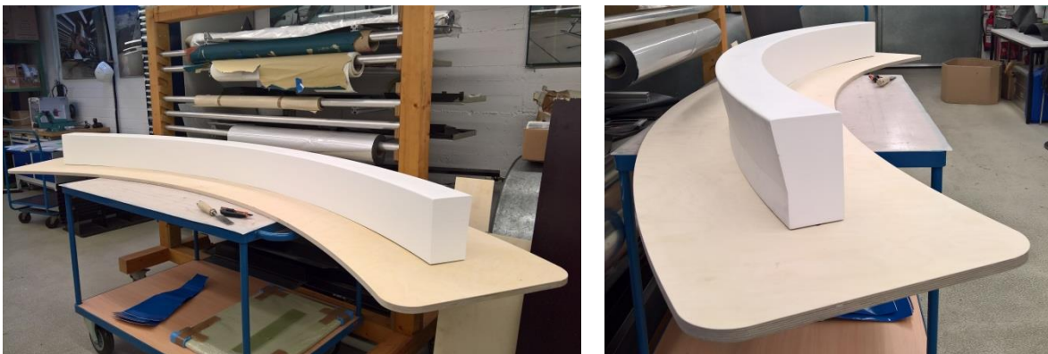
Abbildung 30: Preformwerkzeug für Vorversuche zur Entwicklung einer automatisierten UD-Band-Ablage für Spante im konischen Rumpfbereich
