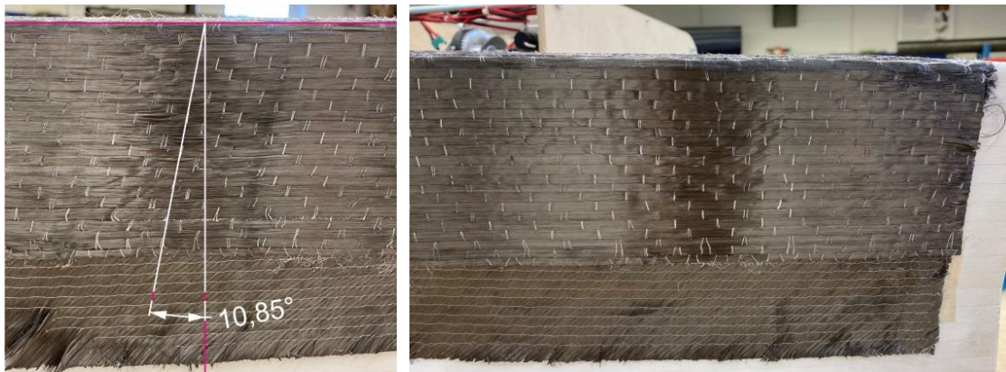
Abbildung 28: Manuelles Drapieren einer UD-Lage von rechts nach links - Beginn der der Anlage des Fasermaterials an die Werkzeuggeometrie ohne Drapiereffekt (rechts), Ende der Drapierung am linken Ende des Werkzeugs (links)
