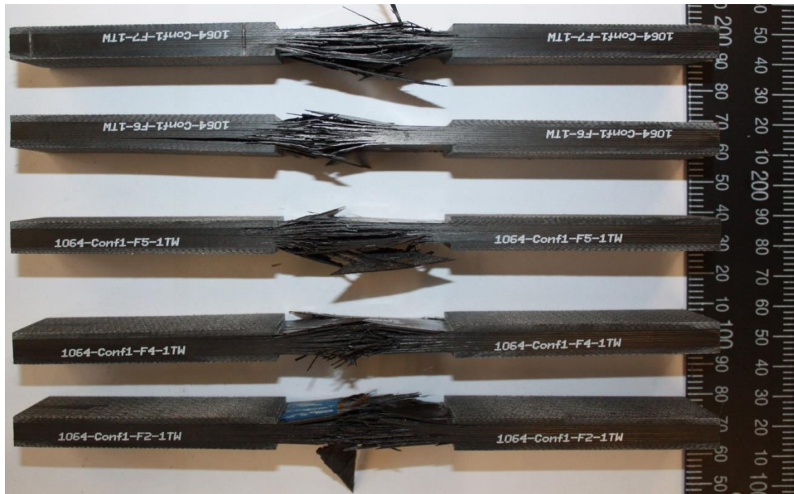
Abbildung 55: Getestete Travellerprüfkörper (Zugproben aus Steg)
