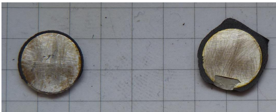
Abbildung 56: Unterseite der Sensoren nach Entfernen vom Formwerkzeug
