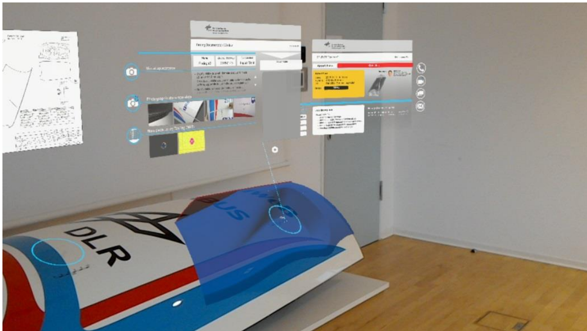
Abbildung 13: Beispielbild aus dem MRO-Szenario zur Inspektion auf Oberflächenschäden des Airbrake-Demonstrators.
