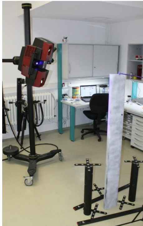
Abbildung 48: ATOS-Vermessung eines geraden NCF-Spantes
