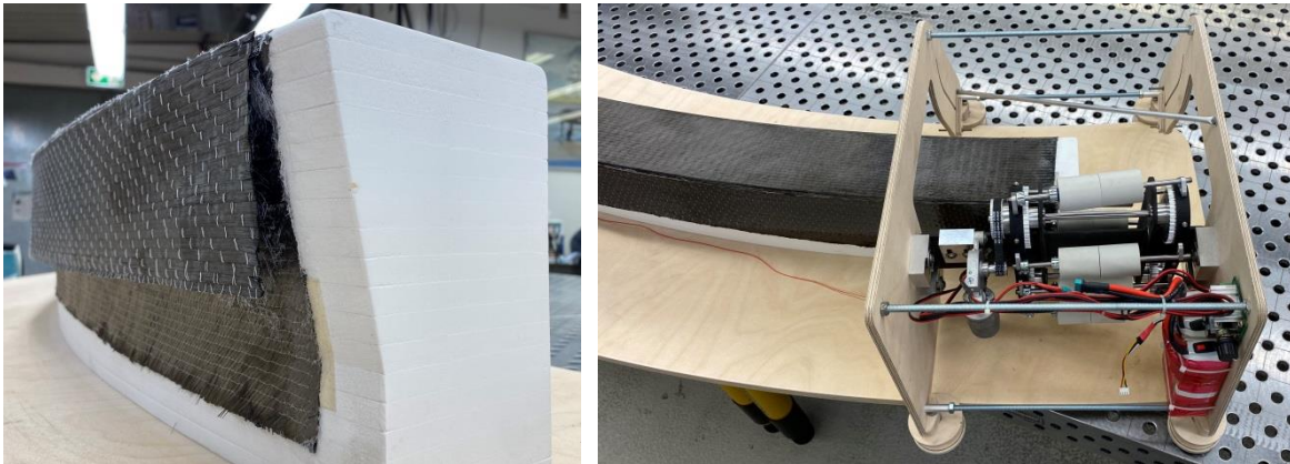
Abbildung 32: Preformwerkzeug mit einer am oberen Rand fixierten Lage UD-Band des Halbzeugs A (links); Positionierung der Drapierereinheit am rechten Rand des Werkzeugs (rechts)
