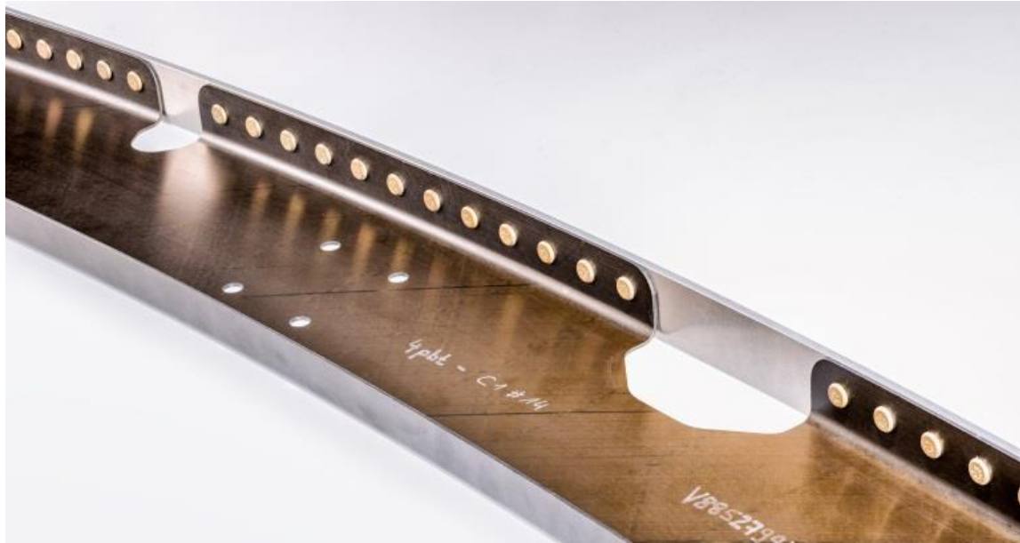
Abbildung 122: Probekörper mit vernieteter Aluminiumversteifung
