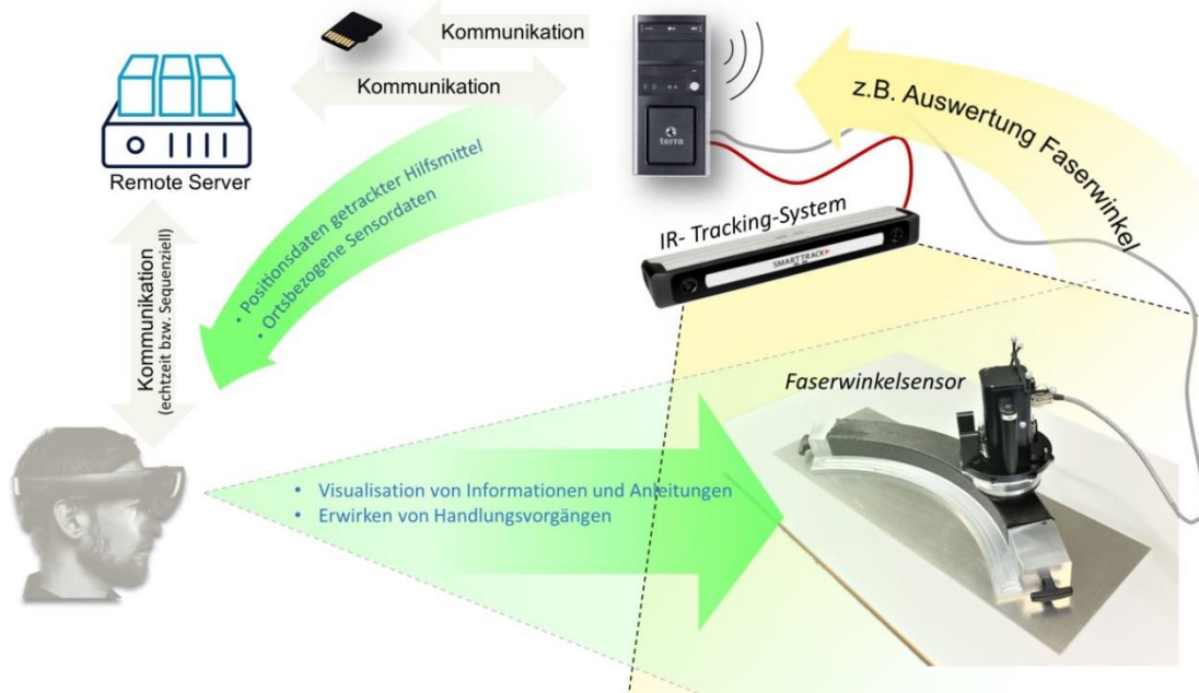
Abbildung 45: Das gleichzeitige Tracken und Visualisieren; Lösung: externes IR-Tracking-System + HoloLens
