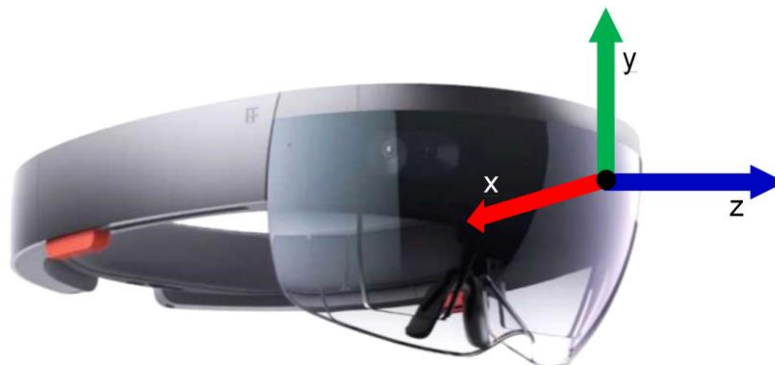
Abbildung 38: Microsoft HoloLens mit einem 3D-Koordinatensystem mit ihrer aktuellen Pose als Ursprung
