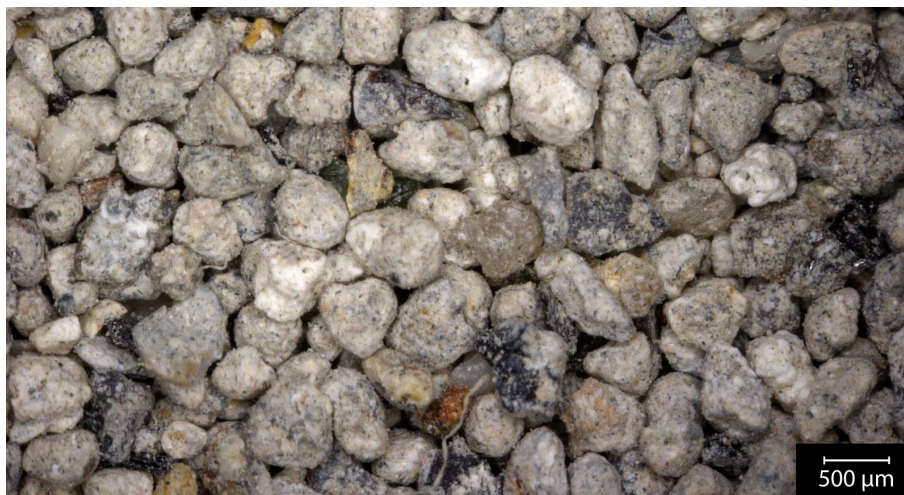
Abb. 26: Aufnahmen mit dem Digitalmikroskop der Fraktion 0 - 710 \mu\text{m} aus der Beta-Linie (SRH-Material)
