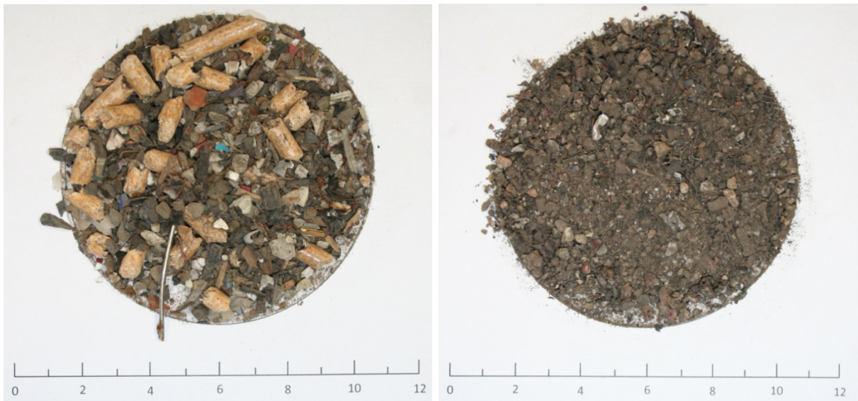
Abbildung 48: 75 Ma.-% EAG- Behandlungsrückstände + 25 Ma.-% Holzpellets (links: Brennstoff, rechts: Asche).
