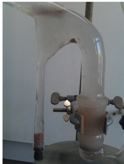
Abb. 8: Schematischer Aufbau der eigens hergestellten Hallimond-Röhre (links) und Trennung von Kupfer und Sand in eben dieser (rechts)
