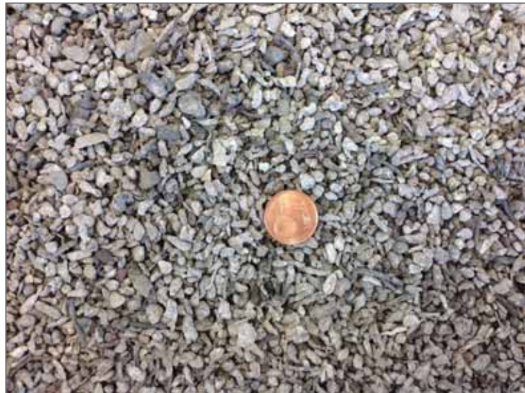
Abb. 27: NE-Metallgemisch aus dem II. Verfahrensschritt
