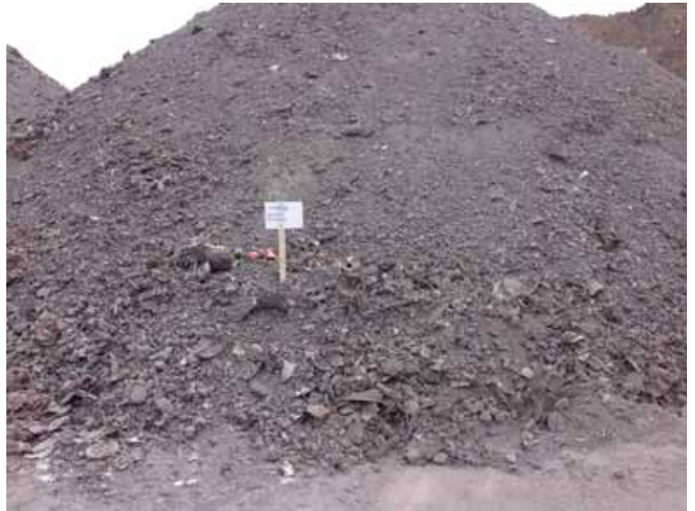
Abb. 3: Einzelhaufwerk der angelieferten SRH-Schlacke „Rohschlacke - MVR“
