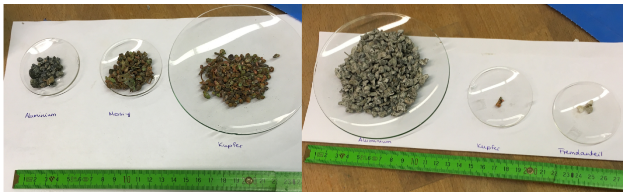
Abbildung 47: manuelle Sortierung Schwer- (links) und Leichtfraktion \beta I-Linie
