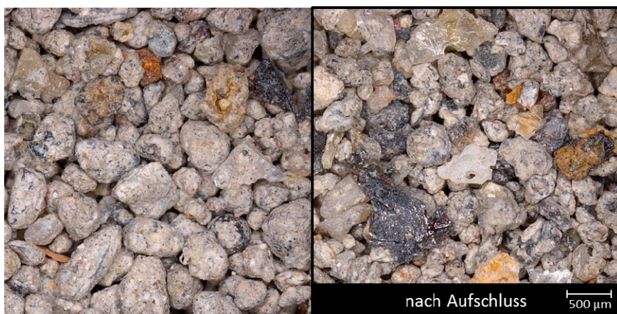
Abb. 24: Aufnahmen mit dem Digitalmikroskop zum Vergleich der Fraktionen vor und nach dem Aufschluss (hier Siebfraktion 200 – 630 μm des SRH-Materials)
