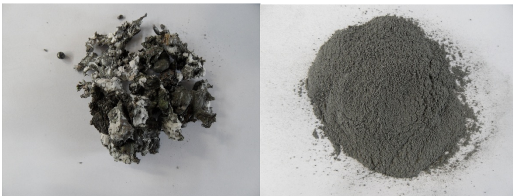
Abbildung 2: Metallische (links) und mineralische (rechts) Fraktion Probe A
