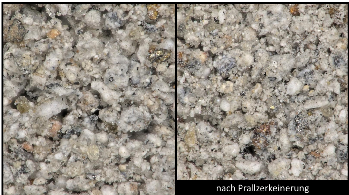
Abb. 2: Einfluss der Prallmühle der TU-Berlin: Ausgangsmaterial (links) und gepralltes Material (rechts); Digitalmikroskopie
