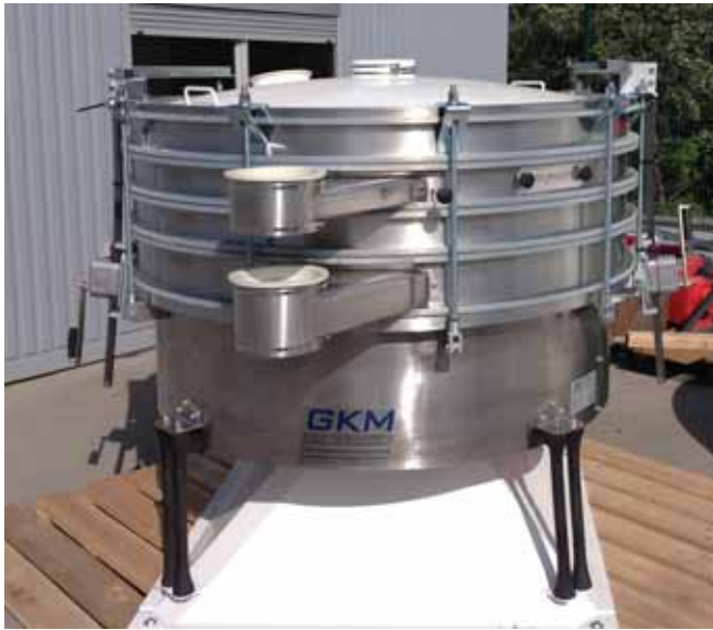
Abb. 22: Klassieranlage für 4 Trennschnitte
