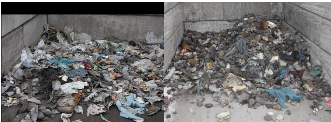
Abbildung 11: Leicht- (links) und Schwerfraktion (rechts) SI Unverbranntes
