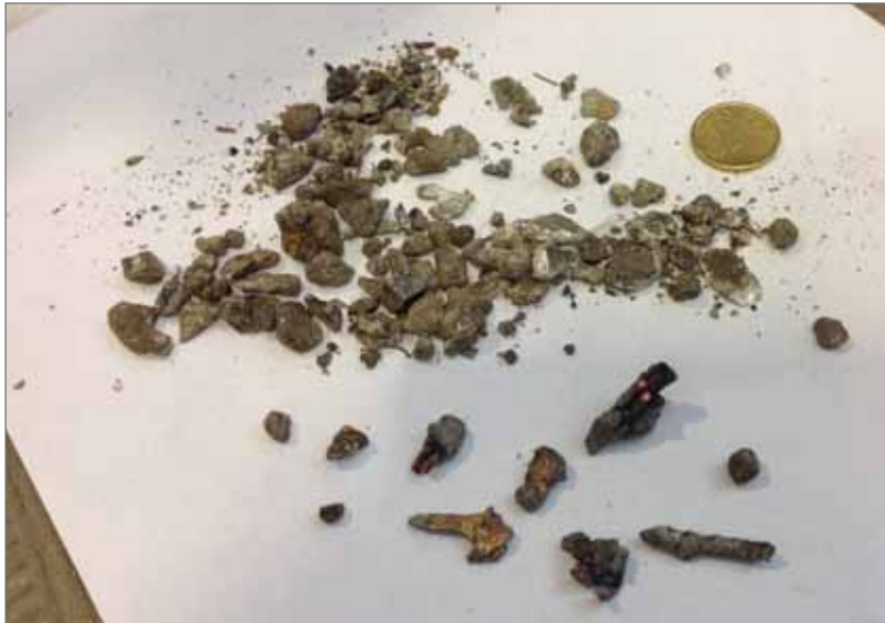
Foto 9: Mit der speziellen Starkfeld-Magnetanlage separiertes chemisch gebundenes Kupfer
