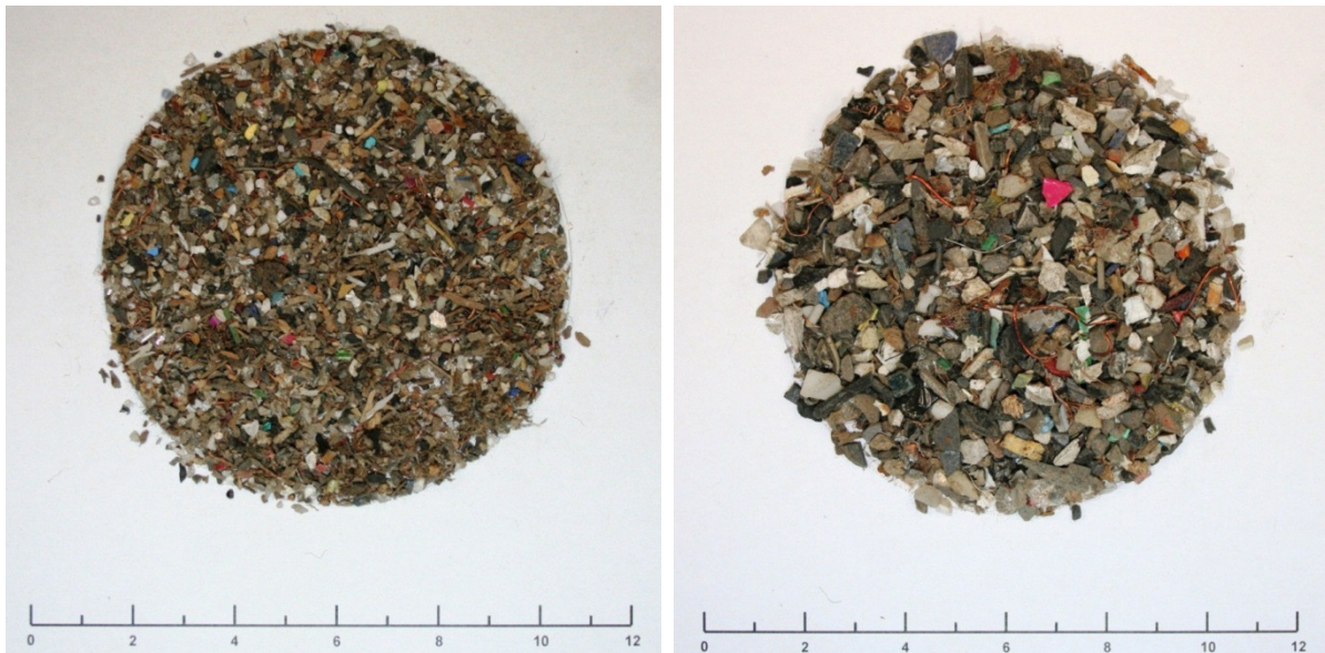
Abbildung 46: Siebfraktion 1,0-2,0 mm (links) und > 2 mm (rechts).
