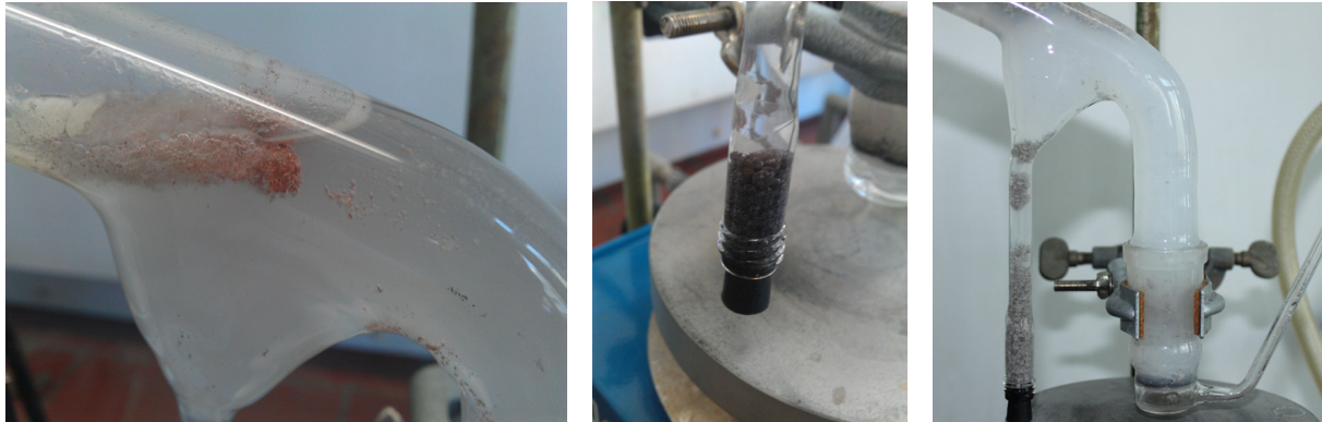
Abb. 12: Gute Anreicherung von Kupfer (links) und Kupfer(II)oxid (Mitte) aus Sand mit Diesel als Sammler; rechts: unspezifische Flotation von HMVA in der Hallimond-Röhre, das Ausgangsmaterial wurde fast vollständig ins Flotat überführt
