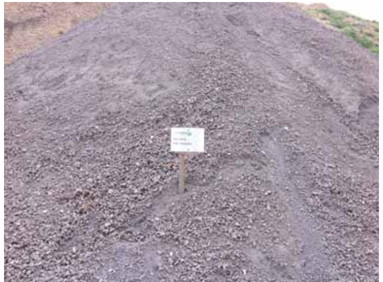
Abb. 5: Einzelhaufwerk der angelieferten SRH-Schlacke „kalzinierte Schlacke - MVB“
