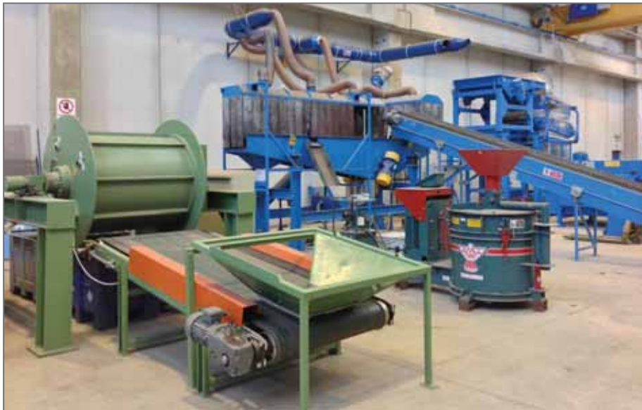
Foto 8: Die spezielle Starkfeld-Magnetanlage (grün) im Technikum in Manerbio.
