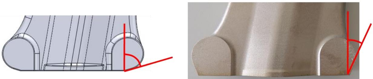
Abbildung 41: Beispiel zur Reduzierung des Überhangs: links: ursprüngliches CAD-Modell mit 75°-Überhang; rechts: Umsetzung mit 15°-Überhang.
