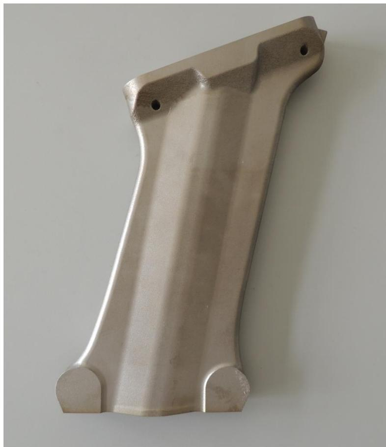
Abbildung 43: Demo-Rohteil, hergestellt mittels SLM
