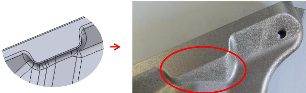
Abbildung 40: Beispiel zur Reduzierung des Überhangs: links: ursprüngliches CAD-Modell mit 90°-Überhang; rechts: Umsetzung mit 45°-Überhang.
