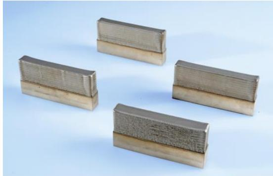
Abbildung 52: Festigkeitsproben aus Schmiedematerial (unten) und mittels LPA aufgeschweißtem Material (oben)
