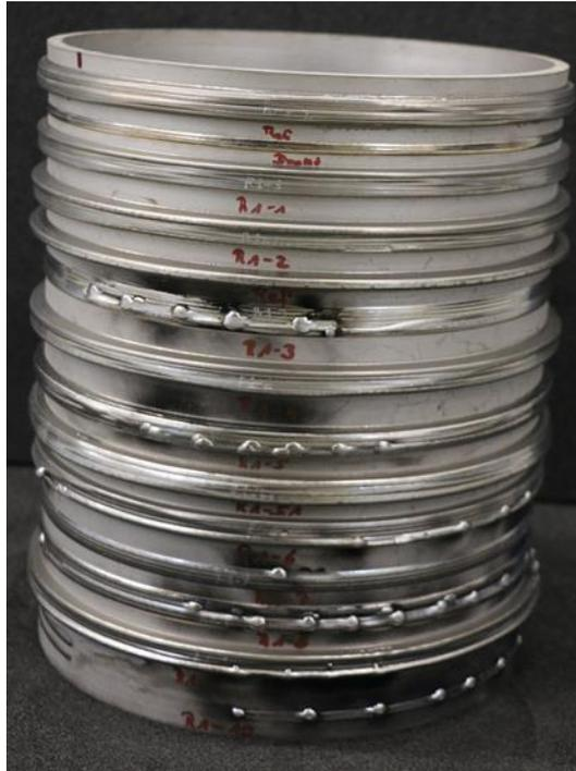
Abbildung 51: Probeschweißungen für umlaufende Features
