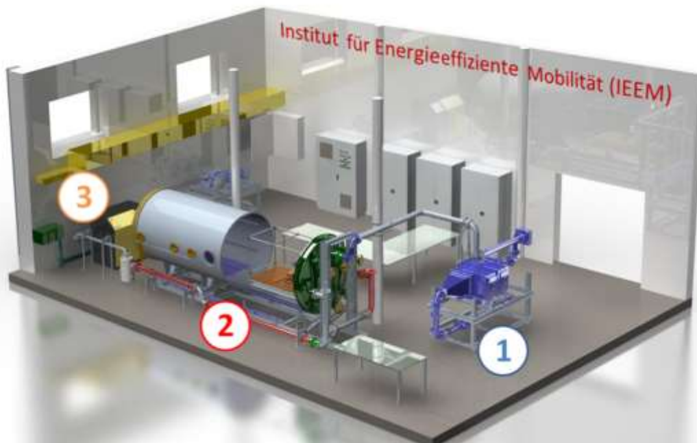
Abbildung 35: Anlagenschema des Klima- und Höhensimulationsprüfstands und Umsetzung in den Laborräumen am IEEM.
