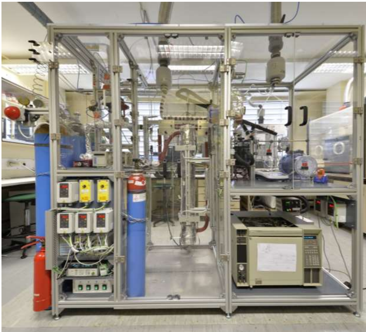
Abbildung 15: Laboranlage zur heterogen katalysierten Ethylen-Oligomerisierung.
