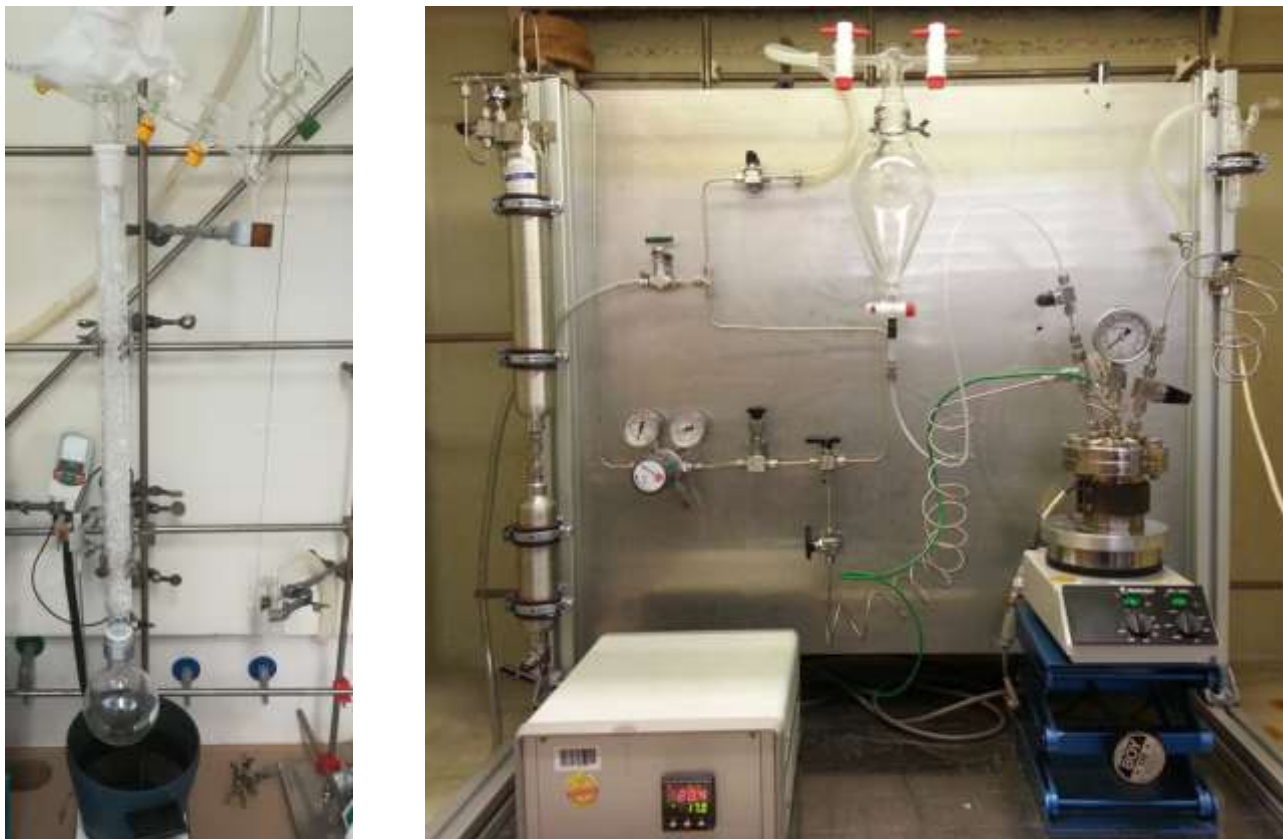
Abbildung 19: Links: Destillationsapparatur zur Abtrennung der hochsiedenden Komponenten des Oligomerbenzins. Rechts: Anlage zur Hydrierung des Rohbenzins.
