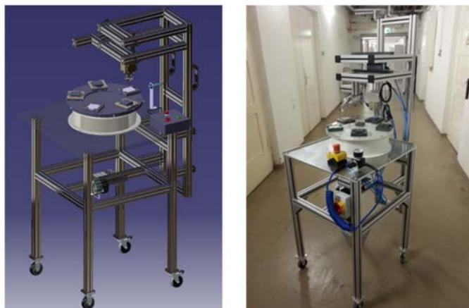
**Abbildung 1:** Darstellung der halbautomatischen Reinigungsmaschine als Konstruktionsabbildung (links) und in der realen Umsetzung (rechts).
