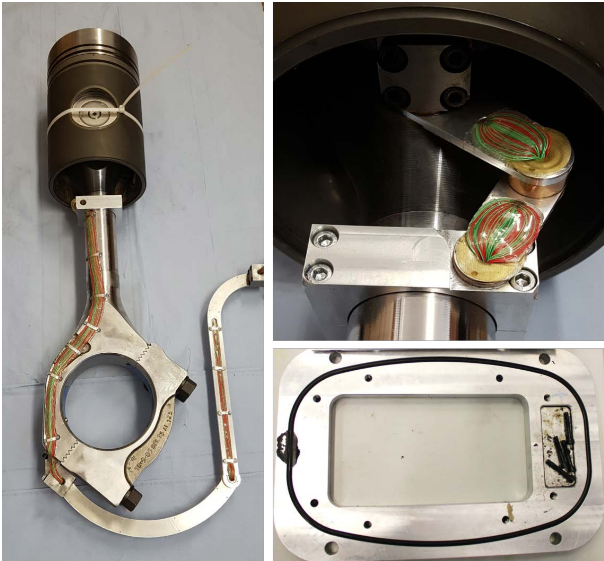
Abbildung 5 Links wird der Messkolben 1 / Basis mit der Messschwinge als Gesamtinstallation dargestellt. Rechts oben wird der Übergang von Kolben zu Pleuel und rechts unten die Eigenkonstruktion der Gehäuseluke jeweils im Fokus dargestellt.
