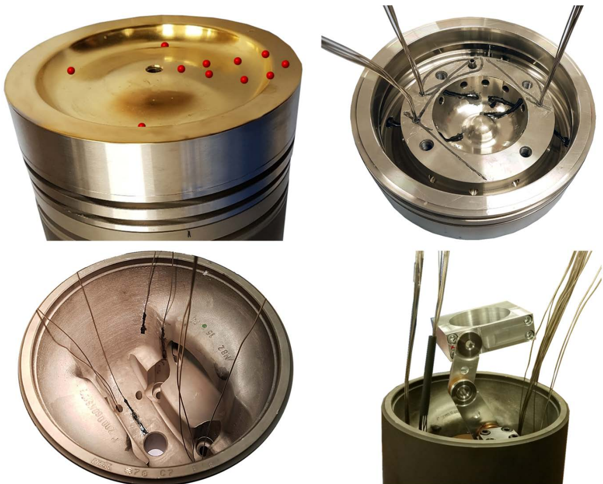
Abbildung 3 Sukzessive Bestückung des Messkolben 1 zusammen mit der Fertigung des dazu angepassten Schwingensystems. Oben links wird die bedampfte Goldschicht dargestellt, wobei die nicht mehr sichtbaren Messstellen der Oberflächenthermoelemente als rote Punkte visualisiert werden. Oben rechts wird die Unterseite der Pleueloberseite und unten links die Unterseite des Pleuelunterteils dargestellt, jeweils mit den ersten Thermoelementen und deren Verlegung im Material. Unten rechts werden die gefertigten und zusammengesetzten Schwingenelemente als Führung von Pleuel zum Pleuel dargestellt.
