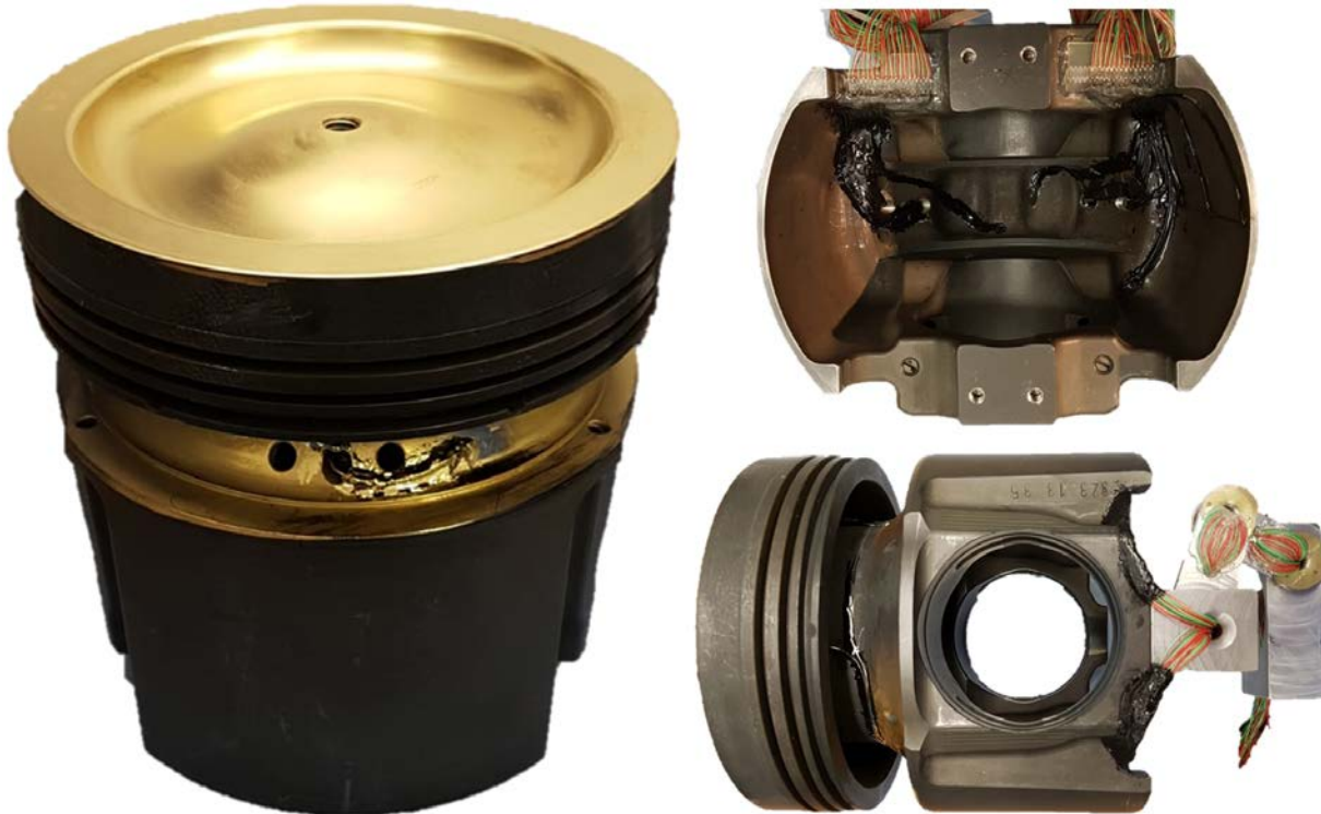
Abbildung 14 Darstellung des bestückten Messkolbens 2 zusammen mit den oberen Schwingenelementen. Links wird die bedampfte Goldschicht über den Messstellen der Oberflächenthermoelemente an der Kolbenkrone und an der Innenseite des Kühlraums dargestellt. Oben rechts werden die zum Kolbenboden geführten und fixierten Thermoelemente an der Unterseite des Kolbens dargestellt. Unten rechts werden die oberen Schwingenelemente als Führung von Kolben zum Pleuel dargestellt.
