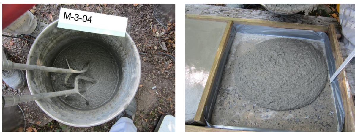
Bild 1 u. 2: links: händisches Anmischen des Mörtels; rechts: Quantifizierung der Fließfähigkeit des Mörtels M-3-04
