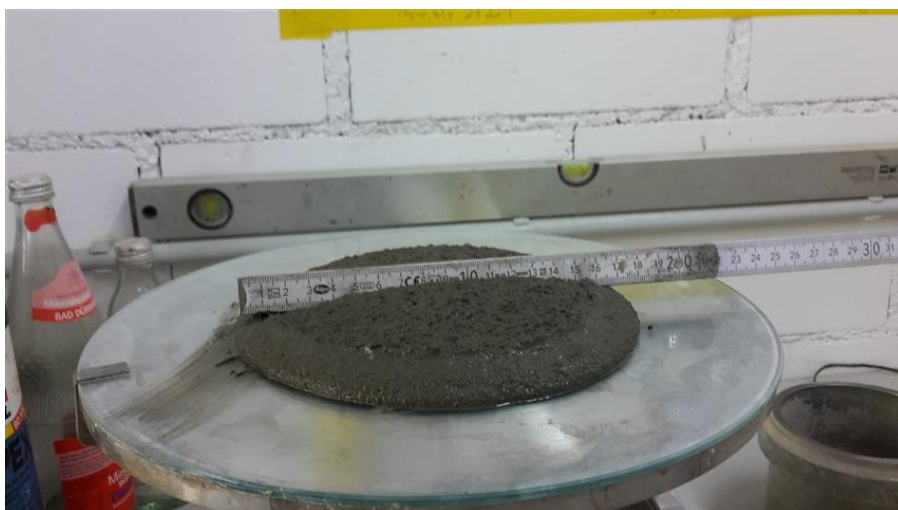
Bild 18: Mit PP-Fasern Ausbreitmaß nach der Prüfung
