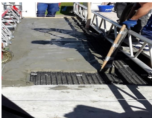
Bild 8: Frischmörtel Verarbeitung Kleindemonstrator
