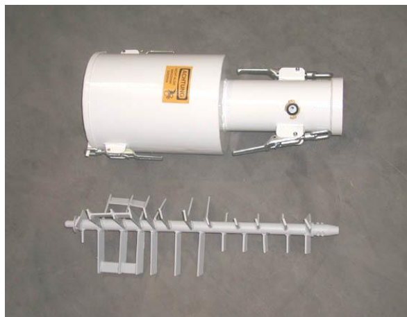
Bild 7: Doppelstufigemischrohr und Mischwelle
