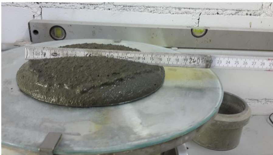
Bild 19: Ohne PP-Fasern Ausbreitmaß nach anheben des Trichters
