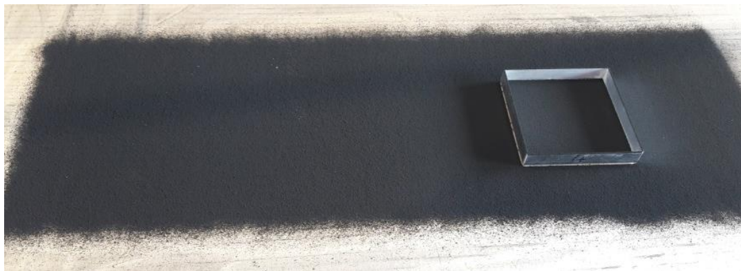
Abbildung 15: Streubild einer Kathodenmischung mittels Pulverstreuer bestreuten Fläche von ca. 700 mm x 200 mm
