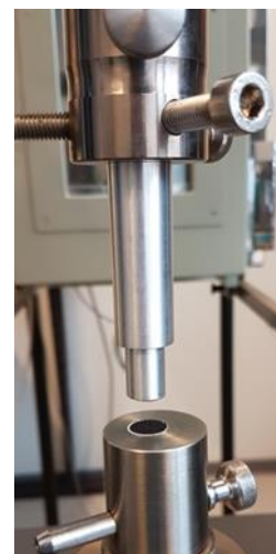
Abbildung 19: a) Ergebnis des Zugversuchs an trockenbeschichteten Elektroden mit verschiedener Flächenbelastung im Vergleich zur Referenzkathode/-anode aus dem Projekt QS-Cell. b): Apparativer Aufbau an der Zugprüfmaschine.
