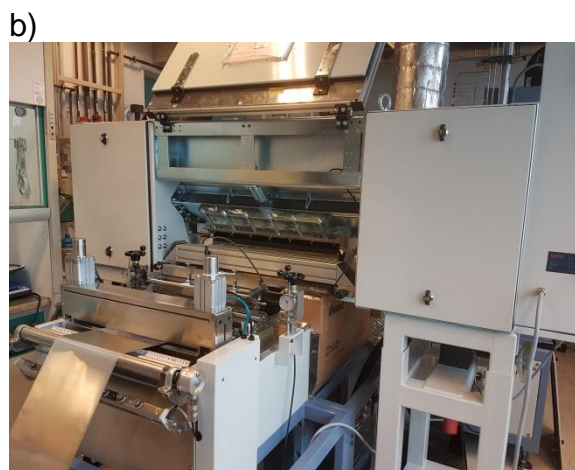
Abbildung 16: Ansichten der installierten Pulverstreuereinheit an der Beschichtungsanlage aus Blickrichtung a) der Trockenstrecke b) der Abwickel­einheit der Beschichtungsanlage
