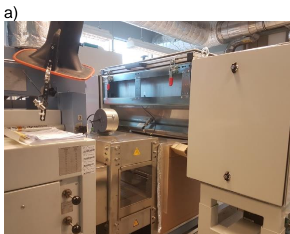
Abbildung 16: Ansichten der installierten Pulverstreuereinheit an der Beschichtungsanlage aus Blickrichtung a) der Trockenstrecke b) der Abwickel­einheit der Beschichtungsanlage
