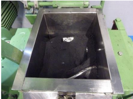
Abbildung 4: a) Kneiter der Fa. Linde, genutzt zur Vorgranulierung der Massen. b) Doppelschneckenextruder (Brabender) genutzt zur Mischung und Beschichtung der Massen. c) Granulat aus dem Vormischungsschritt im Kneiter d) Breitschlitzdüse am Extruderausgang während der Direktbeschichtung auf den Ableiter
