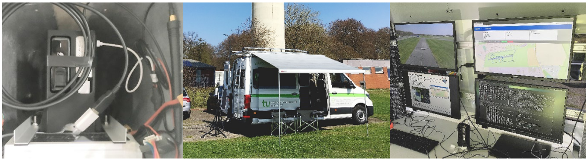
Abbildung 39: Integrierte erste Version des Communication Gateways (links), Bodenstation (Mitte) und Missionssteuerung in der Bodenstation (rechts) beim ersten Integrations-Flugtest.
