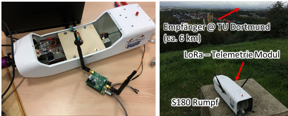
Abbildung 45: Integration und Validierung der LoRa Telemetrie mit dem S180 UAV. Links: Integration des LoRa Telemetrie Moduls im Rumpf des S180. Rechts: Validierungstest in Dortmund.
