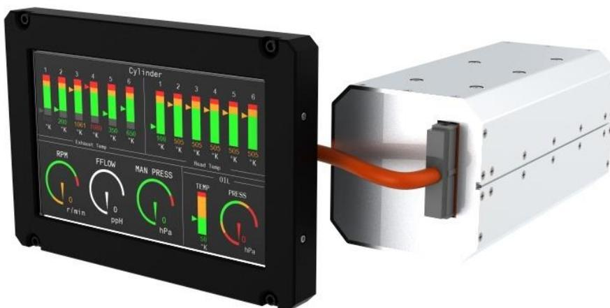
Abb.2: EDM-23 System - Display mit Triebwerksanzeigen und Rechner -
