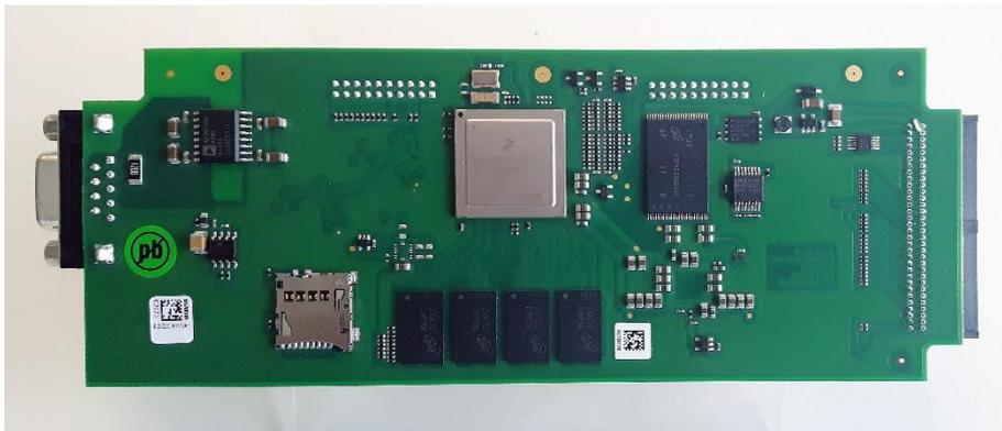
Abb.3: Rechnermodul ESI-23 Konzept aus LuFo 4
