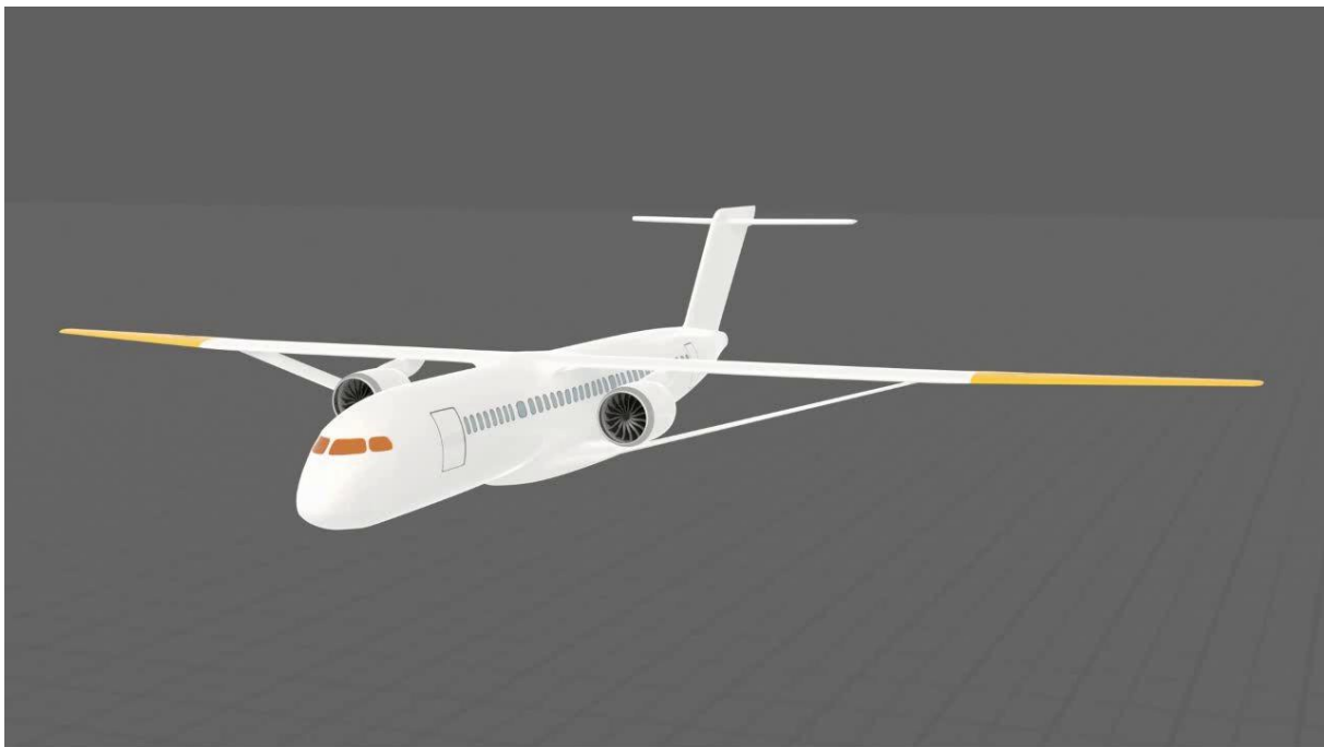
Abbildung 25: 3D-Darstellung der Referenzkonfiguration basierend auf dem Entwurf NASA SUGAR High 765-095-RevD.
