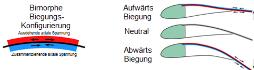
Abbildung 5: Piezoelektrisches bimorphes Prinzip, nach [15].
