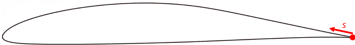
Abbildung 74: Laufkoordinate s entlang des Flügelprofils.
