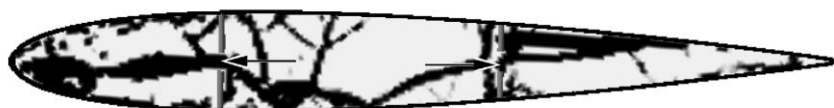
Abbildung 107: Dichteverteilung der unverformten inneren Struktur eines Flügelprofils bei Vorgabe der Aktuatorpositionen, aus [186].
