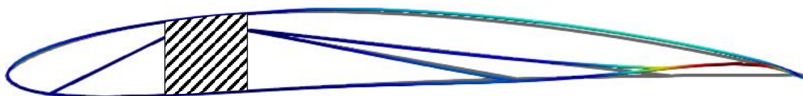
Abbildung 160: Ausgewähltes Individuum der Optimierungsrechnung mit |\varepsilon| \leq 0,5\% , verformt für den Flugzustand 3.
