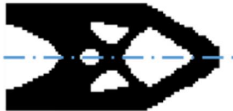
Abbildung 93: Ergebnis der Level-Set Optimierung von Guirguis und Aly als Vergleichsstruktur, aus [177].
