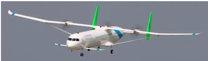
Abbildung 29: Demonstrator „V1 plus“ von COMAC im Flugtest als 1:10 Modell eines Strut Braced Wing Verkehrsflugzeugs, aus [60].
