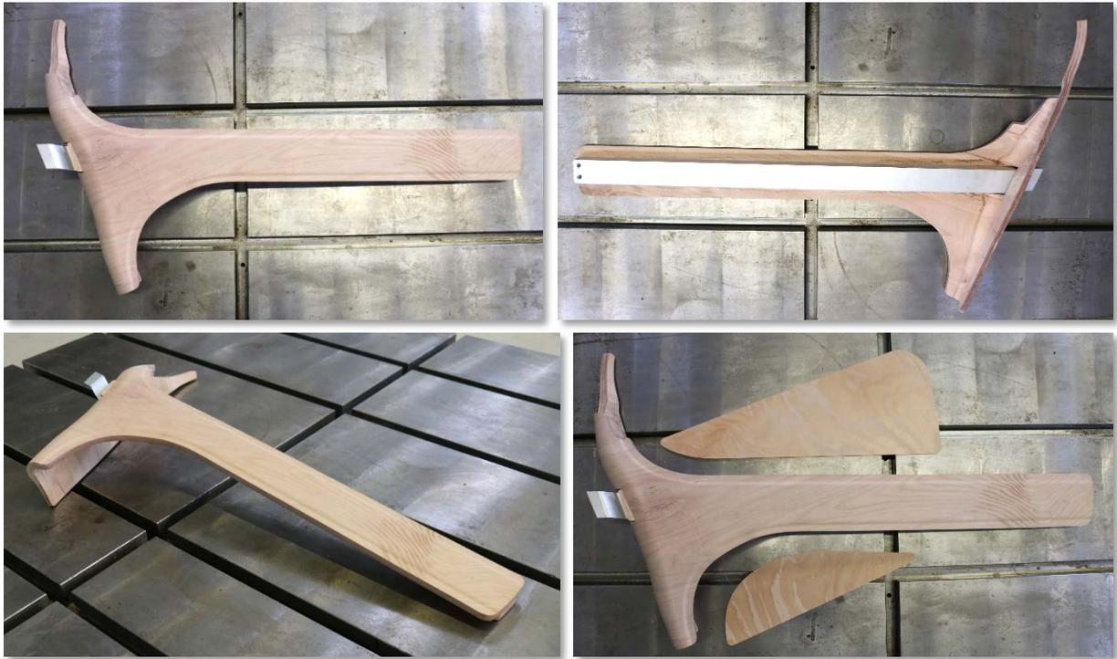
**Abbildung 54: Baugruppe des holzbasierten funktionsintegrierten Türinnenteils (Akustikdämmplatten noch nicht verklebt)**
