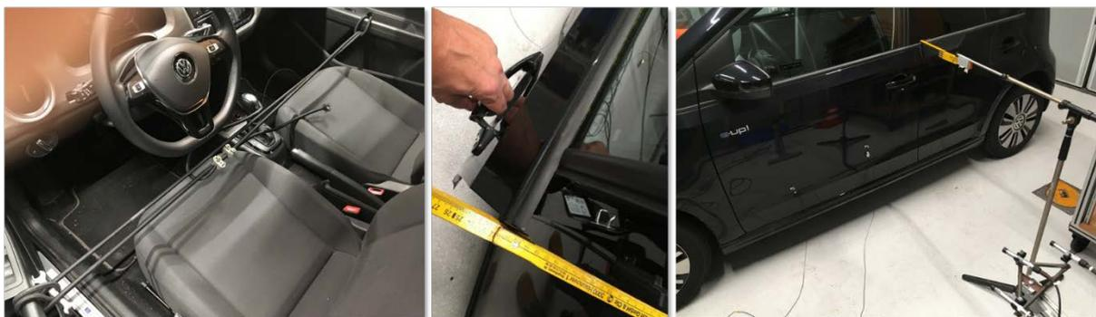
**Abbildung 30:** links: Expander zwischen den Türgriffen innen; Mitte: Öffnung der Tür auf einen definierten Abstand; rechts: Einrichtung von Messmikrofonen in 1 m Abstand zum Fahrzeug
