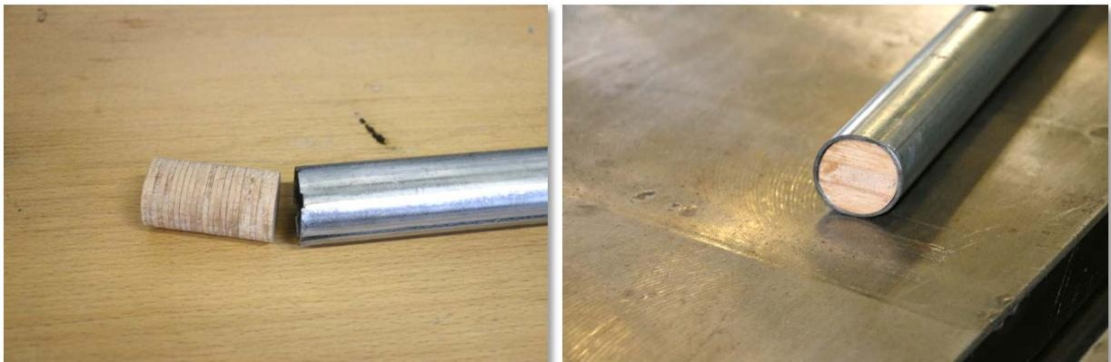
**Abbildung 53: Modifiziertes Crashrohr mit Holzstopfen**
