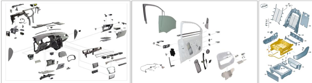
**Abbildung 1: Links: Instrumententafel des Passat B8 mit Cockpit-Modulquerträger; Mitte: Fahrertür des VW UP!; Rechts: Fahrersitz des VW Crafter/T6**
