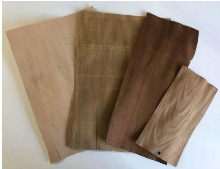
**Abbildung 39: Buchenfurniere für die Emissionsprüfung, von links nach rechts: unbehandelt, acetyliert, thermisch modifiziert, KTL-behandelt**
