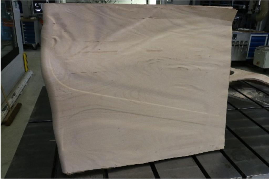
**Abbildung 51: entformter Pressling, noch nicht besäumt**
