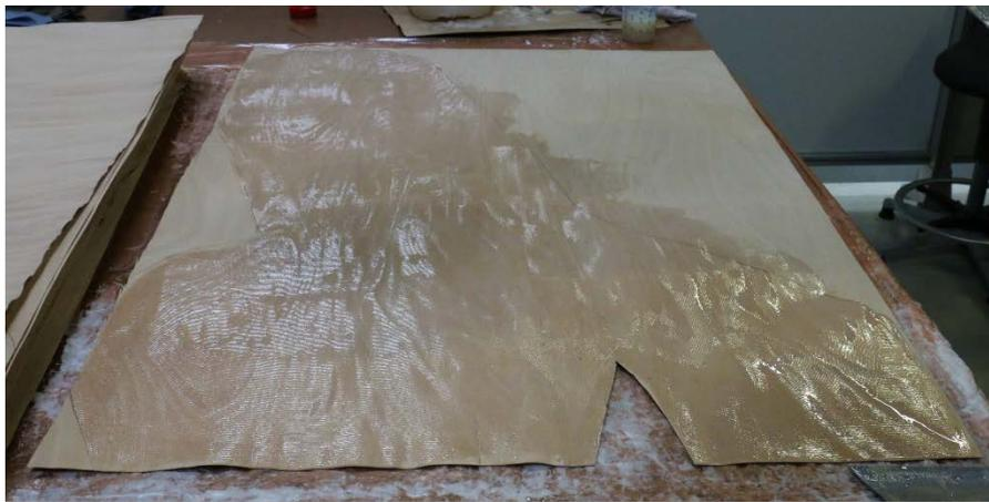
**Abbildung 50:** Beleimte Furnierlage mit dreieckigem Einschnitt im Bereich der Verwerfung auf der kurzen Bauteilseite
