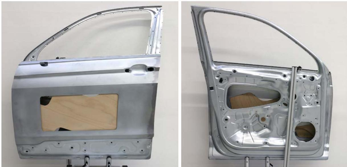
**Abbildung 13: Demonstratorbauteil (K3) in Türrohbau**
