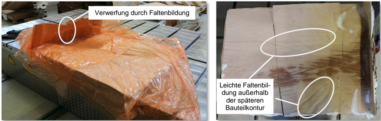
**Abbildung 49:** links: aus Presse entnommener Stapel in Schutzfolie mit Verwerfung auf der kurzen Bauteilseite; rechts: erstes Pressergebnis mit leichter Faltenbildung auf der langen Bauteilseite
