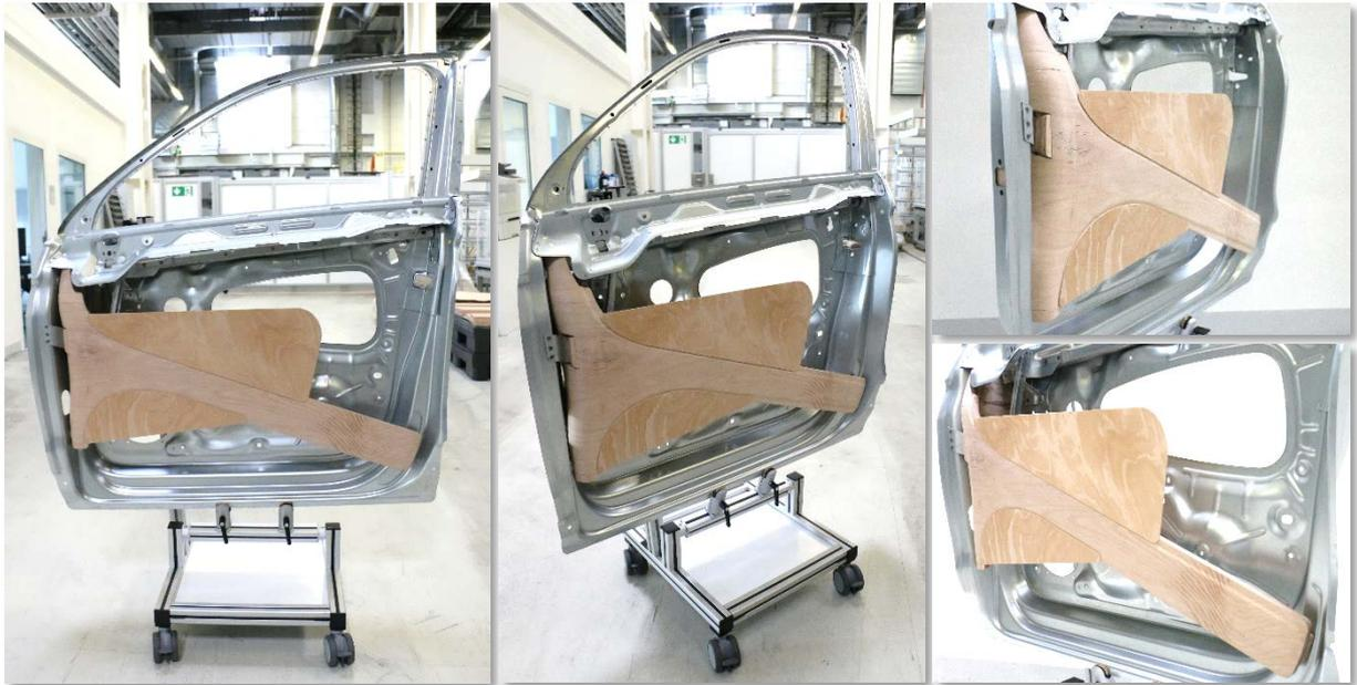
**Abbildung 55: Türrohbau mit holzbasiertem funktionsintegriertem Türinnenteil (ohne Türäußenblech)**
