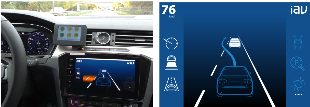
Abbildung 19: VAVF-HMI für die Darstellung des kooperativen Fahrstreifenwechsels (© IAV/SAENA)
