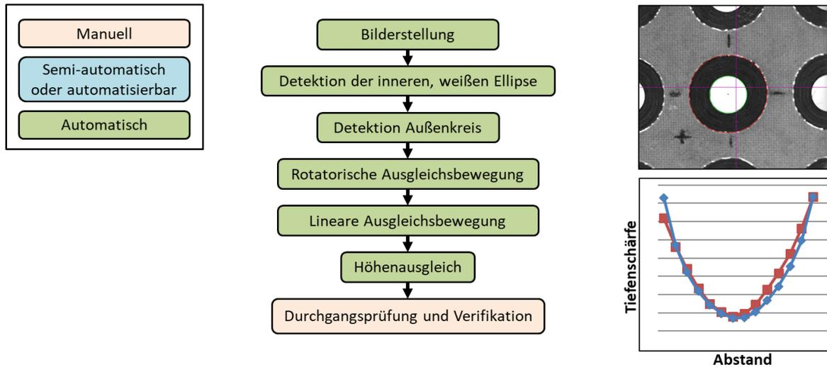
**Abbildung 12:** Ablaufdiagramm der Kamera-basierten Positionsbestimmung, © Fraunhofer
