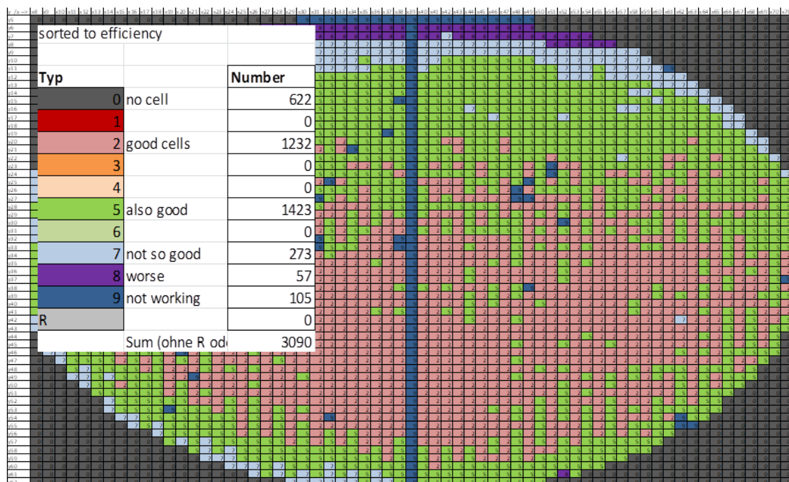
Abbildung 14: Wafermap für den Wafer 03(PGL587-011) sortiert und ausgewählt in Bins nach der Höhe der Effizienz.
