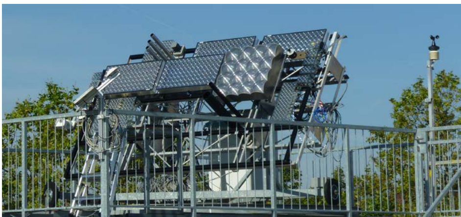
Abbildung 2: Außenteststand zur Vermessung von CPV Modulen auf dem Dach des Fraunhofer ISE in Freiburg.
