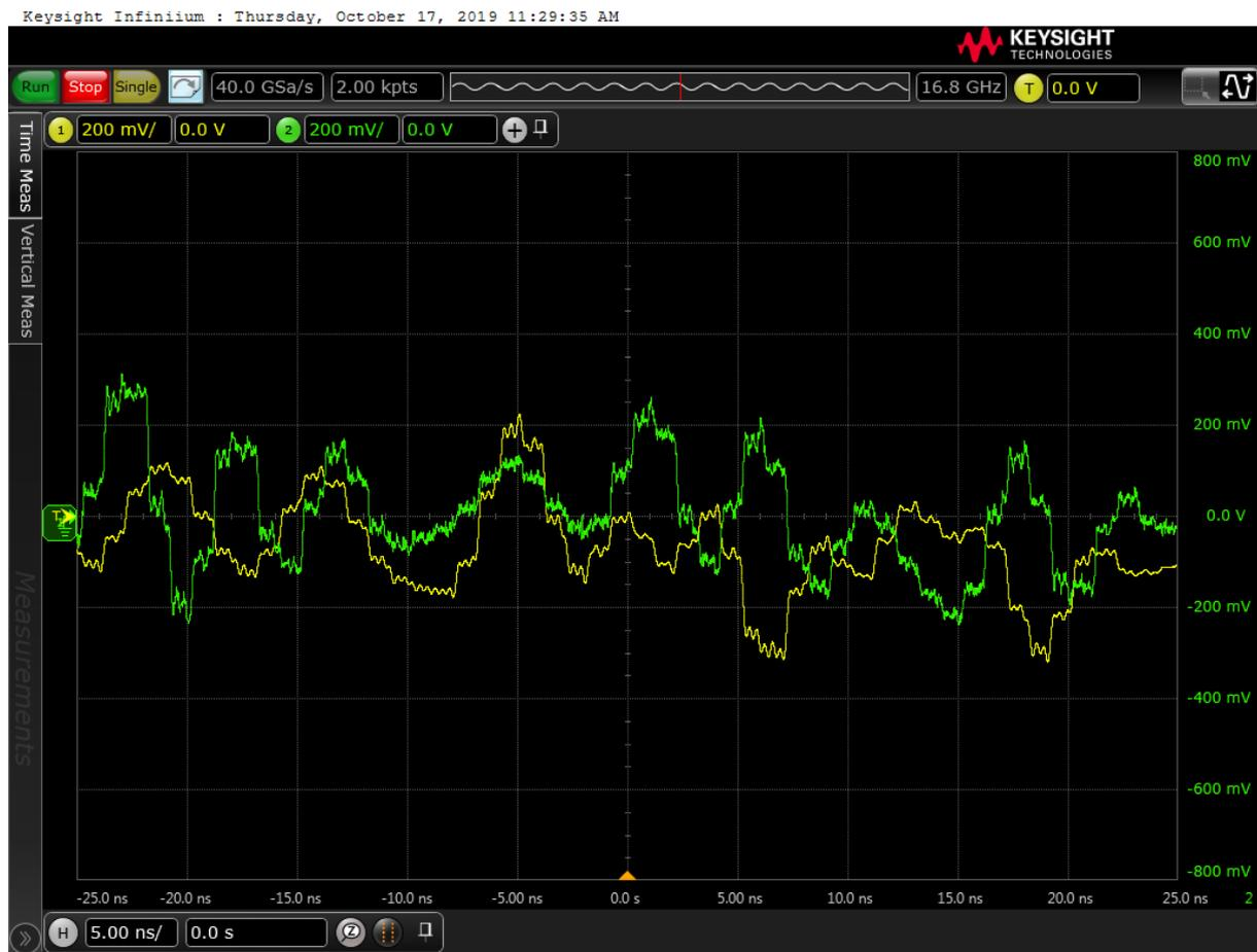
Abbildung 12: Ausschnitt aus einem digital-analog-gewandelten OFDM-Signal nach dem DAC.
