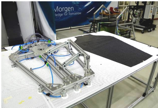
Abbildung 4-27: Transportgreifer mit Zuschnitt
