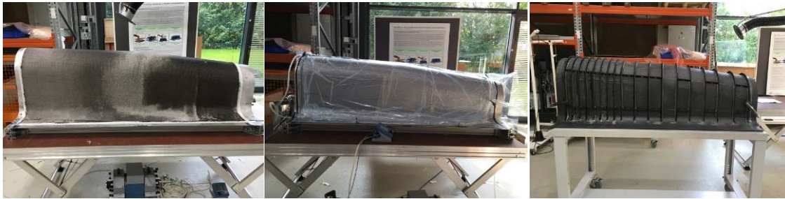
Abbildung 4-30: Aufbau der Drapier- und Kompaktierhaube
