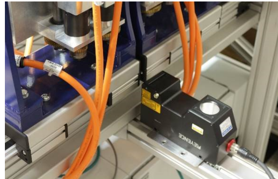
Abbildung 4-50: Bauteilabbild (links) und Laserschnittsensor (rechts)
