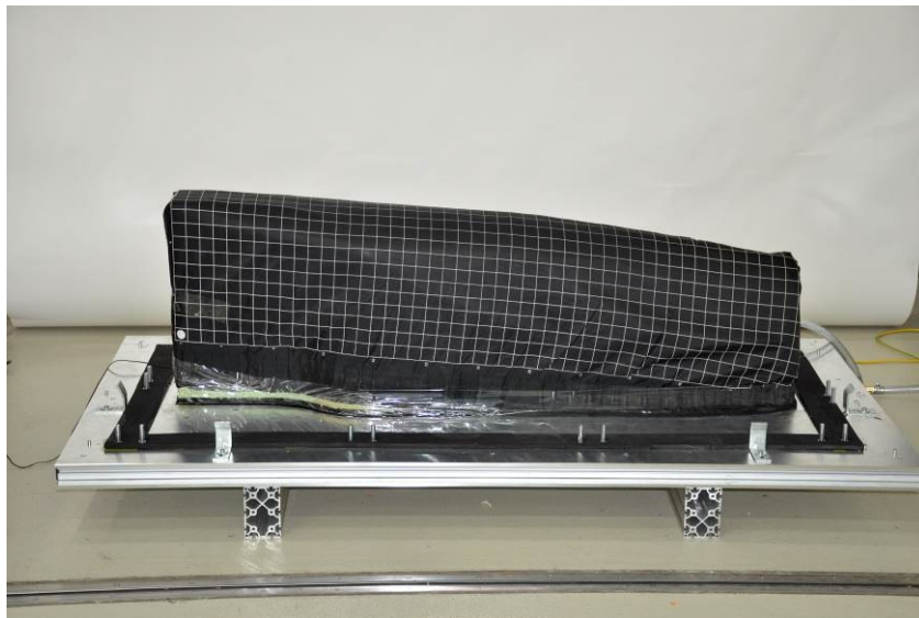
Abbildung 4-32: Versuchsaufbau mit drucksensitiver Matte von XSENSOR
