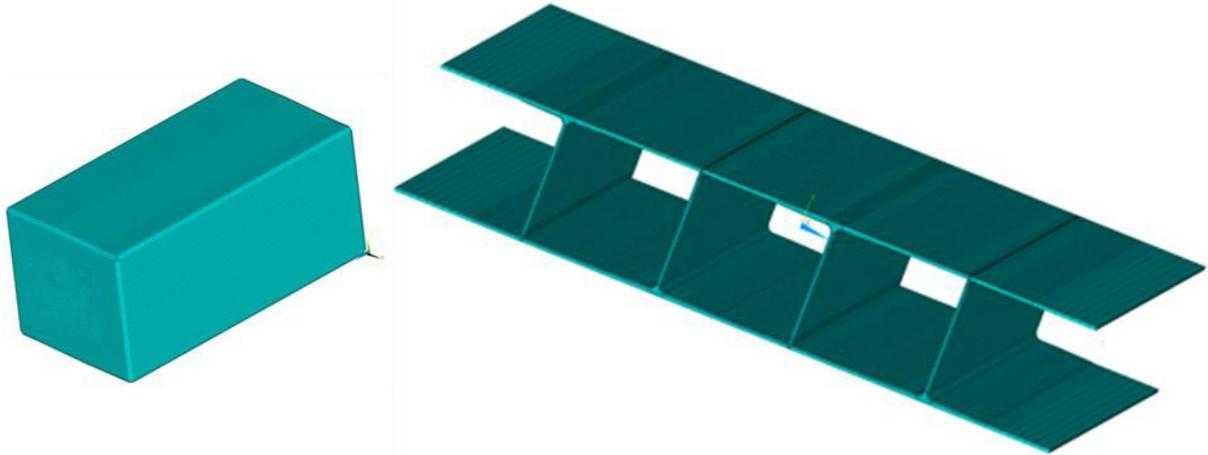
**Abbildung 2-3** FE-Modell eines strukturellen Kerns (links) und eines Landeklappendemonstrators in alter Konfiguration (rechts)
