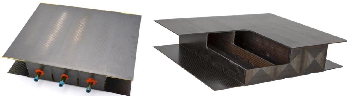
**Abbildung 2-12** Klappendemonstrator (Multicell-Box) in neuer Konfiguration mit drei strukturellen Kernen mittig, links Gesamtansicht, rechts Schnittansicht rückseitig
