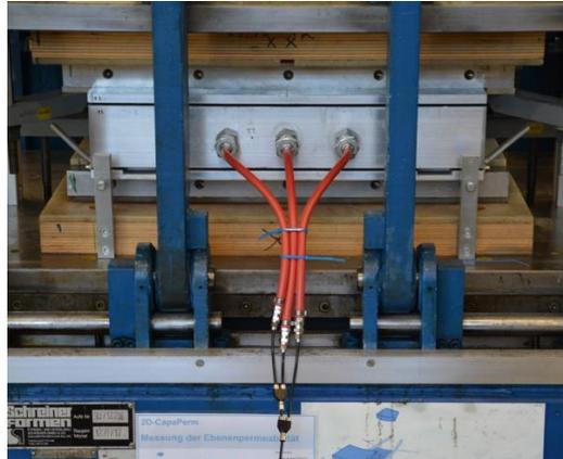
**Abbildung 2-11** Klappendemonstratorwerkzeug mit Druckluftanschlüssen in rot auf Werkzeugträger
