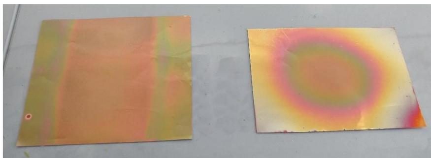
Abbildung 19 Plasmabehandelte Folie (links) und unbehandelte Folie (rechts)
