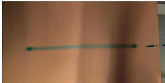
Abbildung 5: Messung der Benetzung nach der Plasmabehandlung auf Kupferfolie
