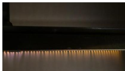
Abbildung 3: Plasmaerzeuger mit Multiauslässen (PFW70)
