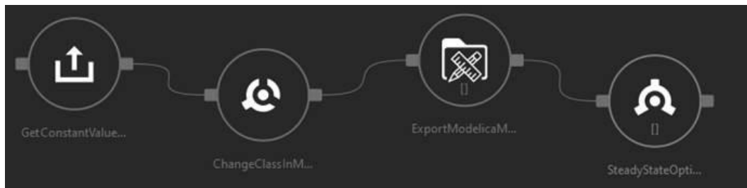
Abbildung 22: Entwicklungsprozess zur Findung einer optimalen Komponentenkonfiguration mit vier Prozessschritten. Von links nach rechts: Datenimport, Modellaustausch, Systemerzeugung und Analyse.
