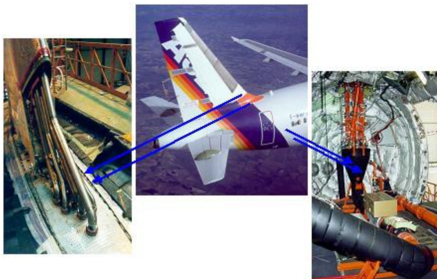
Abbildung 3: Airbus A320 HLFC Seitenleitwerk mit hybrid-laminarer Absaugnase im Flugversuch und Details zum aktiven Pumpensystem. [1]
