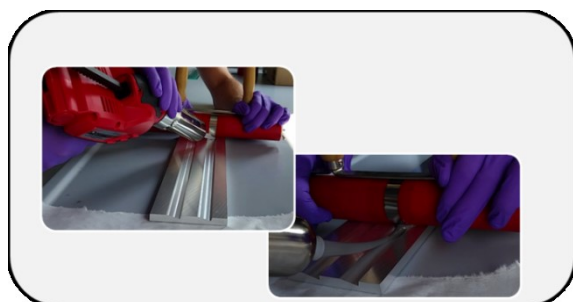
Abbildung 5: Getestete Methoden um komplex geformte Fügeübergänge mit Dichtmasse zu füllen und mit einer Abdeckleiste abzudecken.
