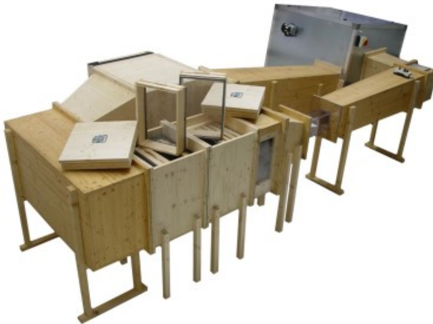
Abbildung 44: Versuchsaufbau zur Untersuchung der Vereisung von mikroperforierten Proben im Vereisungswindkanal iCORE (Airbus Materials X, Taufkirchen).
