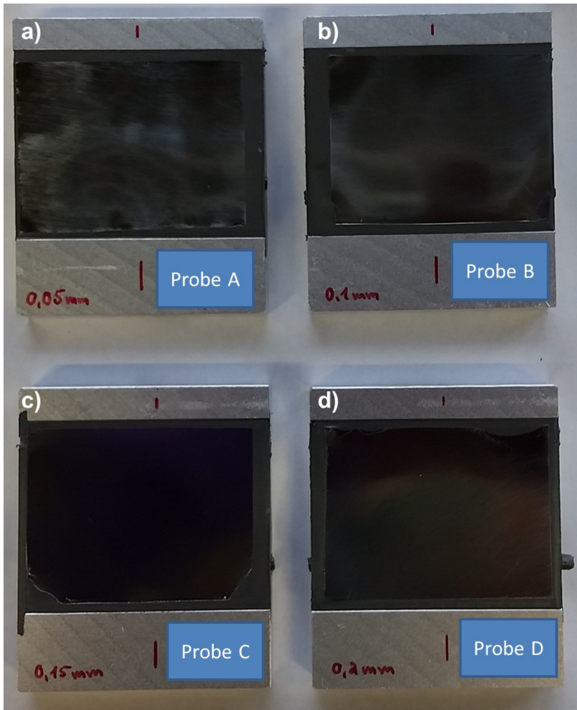
Abbildung 27: Nutproben mit polysulfidbasierter Dichtmasse-A und Abdeckstreifen; Dicke der Abdeckstreifen: 0,05 mm (a), 0,10 mm (b), 0,15 mm (c) und 0,20 mm (d).
