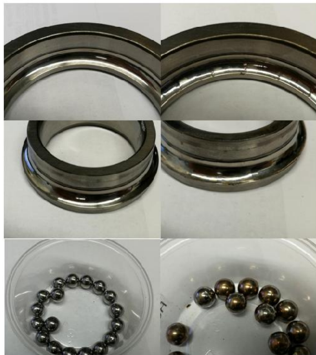
Fig. 23 Außenring (oben), Innenring (Mitte) und Kugeln (unten) jeweils eines unbelasteten Lagers (links, Lager 1) und eines belasteten Lagers (rechts, Lager 3) von Lagerkartusche 2
