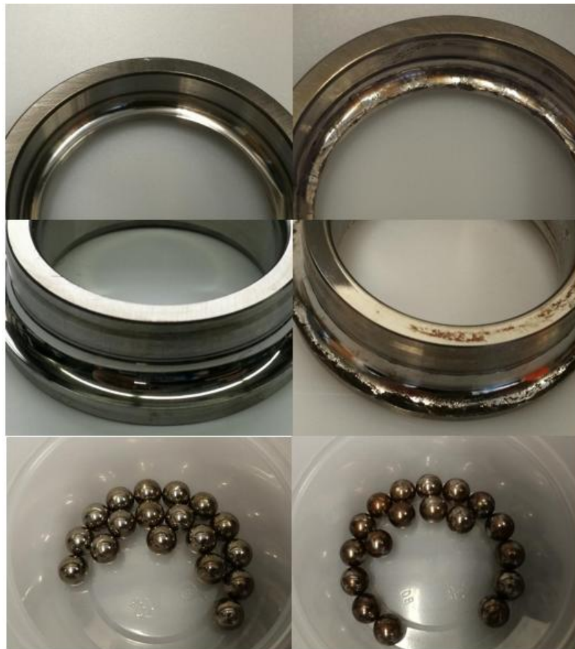
Fig. 24 Außenring (oben), Innenring (Mitte) und Kugeln (unten) jeweils eines unbelasteten Lagers (links, Lager 1) und eines belasteten Lagers (rechts, Lager 4) von Lagerkartusche 3
