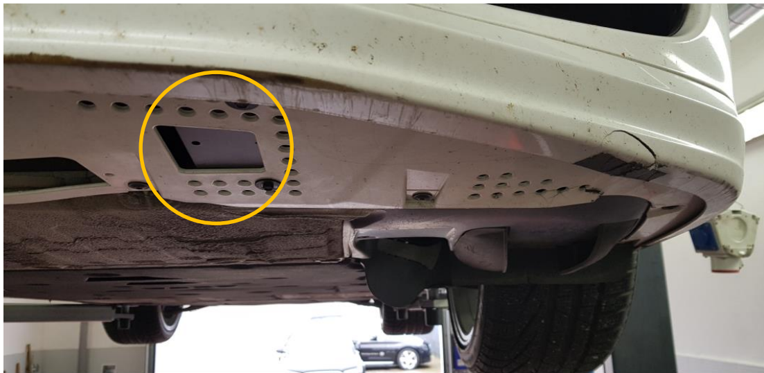
Abb. 25: Radar (gelb umrandet) im Frontbereich des GTS unterhalb des Fahrzeugs appliziert.
