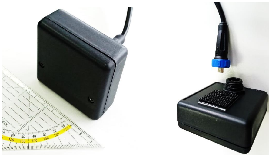
Abb. 13: Vorder- (links) und Rückseite (rechts) des Musters des SEEROAD Radar v2.
