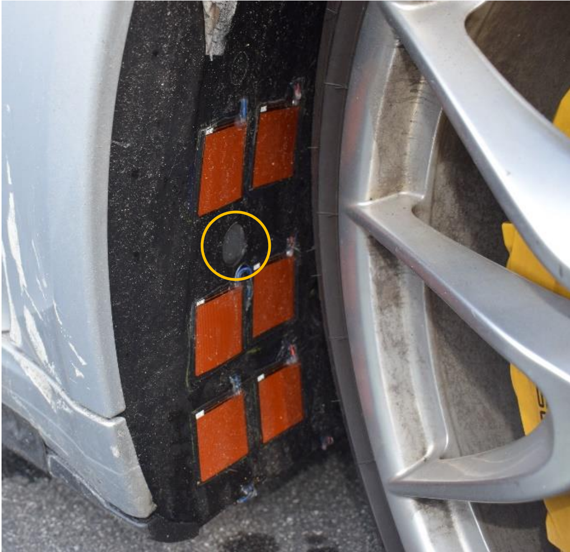
Abb. 20: Radhausschale des C4S mit 6 Elektroden zur kapazitiven Messung (orange) und 1 Membran zur Körperschallmessung (gelb umrandet).
