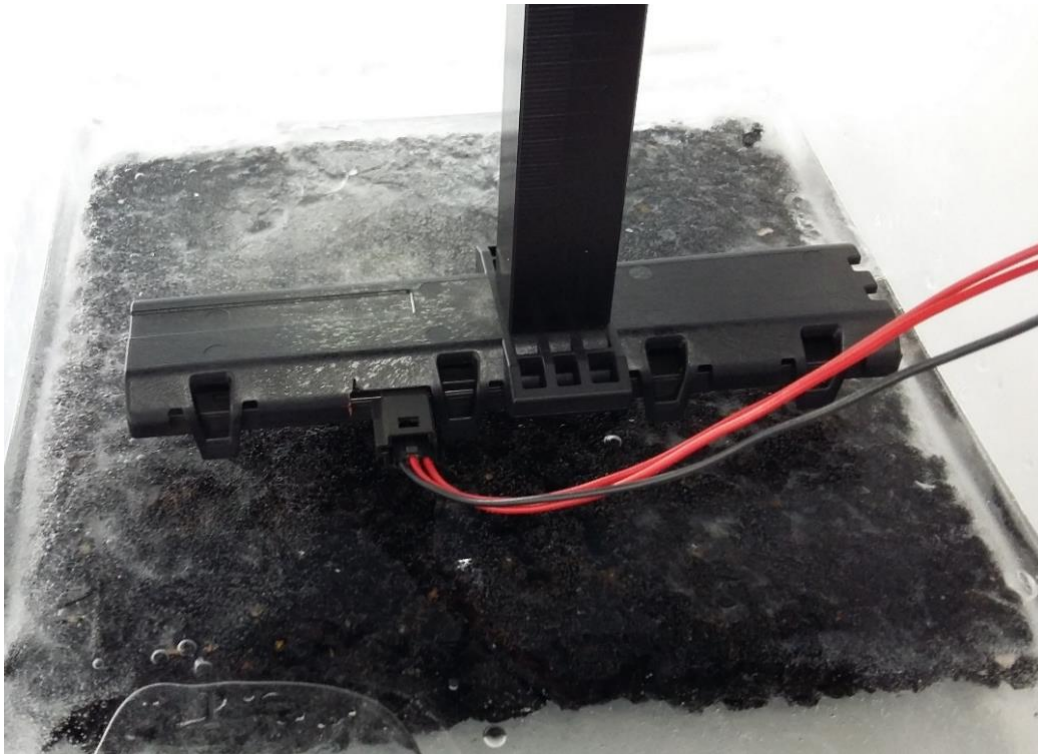
Abb. 4: Stationärer Prüfstand mit Kapazitätssensor und vereistem Asphalt.
