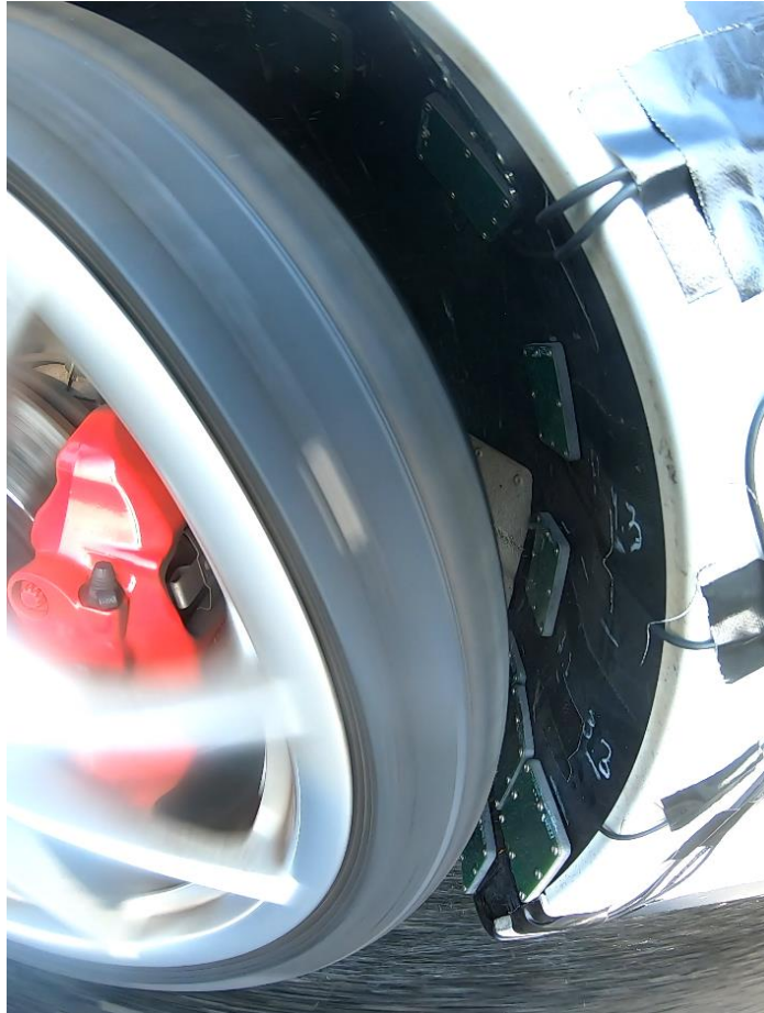
Abb. 21: Kapazitive Sensoren in der Radhausschale des GTS.
