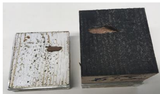
E: Probekörper 6.3, verklebt mit Klebstoff 9 (2K SE), thermische Belastung von 250 °C; Versagensart: Alublech
