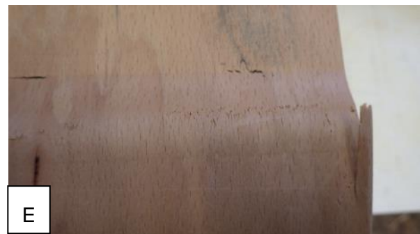
Abbildung 34: L-Profil mit Verdichtungszone. (A) gesamtes Bauteil, (B) verdichteter Bereich, (C) Innenradius mit intakten Furnierlagen, (D) und (E) gebrochene Furnierlagen im Übergangsbereich von Verdichtungszone zu nicht verdichtetem Bereich
