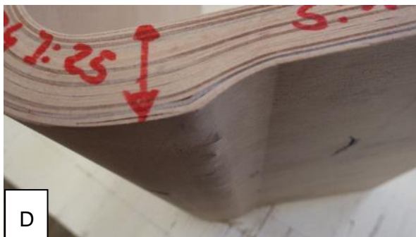
Abbildung 34: L-Profil mit Verdichtungszone. (A) gesamtes Bauteil, (B) verdichteter Bereich, (C) Innenradius mit intakten Furnierlagen, (D) und (E) gebrochene Furnierlagen im Übergangsbereich von Verdichtungszone zu nicht verdichtetem Bereich
