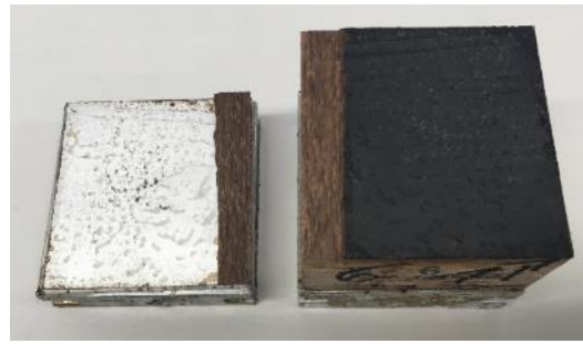
D: Probekörper 6.1, verklebt mit Klebstoff 9 (2K SE), thermische Belastung von 250 °C; Versagensart: 20 % Deckfurnier, 80 % Alublech
