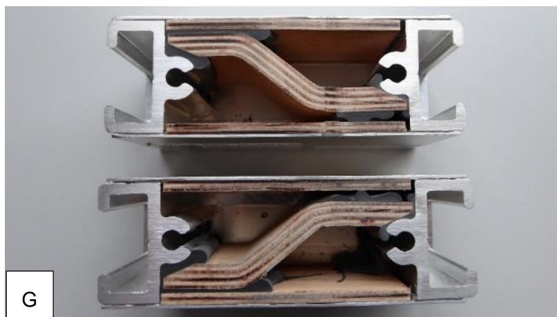
Abbildung 42: Prüfkörper für die brandtechnischen Untersuchungen nach DIN EN 45545-2. A: Einzelne Komponenten (Rahmen, Hutprofile, Außenbleche) für die Herstellung der Prüfkörper zur Bestimmung der seitlichen Flammenausbreitung sowie Wärmefreisetzungsrate. B: Einzelne Komponenten der Prüfkörper zur Bestimmung der seitlichen Flammenausbreitung. C: Klebstoff 8 (Klebeband) und Klebstoff 10 (2K SE) aufgebracht. D: Klebstoff 8 (Klebeband) und Klebstoff 10 (2K SE) auf Probekörpern zur Bestimmung der Wärmefreisetzungsrate. E: Alle Probekörper zur Bestimmung der seitlichen Flammenausbreitung, Wärmefreisetzungsrate sowie Rauchgastoxizität und Rauchdichte, unlackiert. F: Alle Probekörper, lackiert. G: Probe zur Bestimmung der Wärmefreisetzungsrate im Querschnitt. (Fotos: J. Enge, Fa. Bode)
