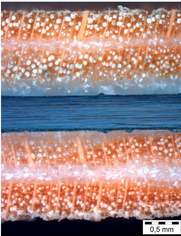
Abbildung 12: 5-lagiger Prüfkörper mit feuerverzinktem Blech als Mittellage, mikroskopische Aufnahme
