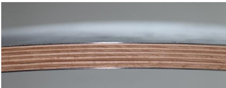
Abbildung 18: Bombiertes Bauteil aus 11-lagigem Buchensperrholz sowie zwei metallischen Deckschichten, hergestellt im Autoklav, Nahaufnahme (Foto: VOLKSWAGEN)
