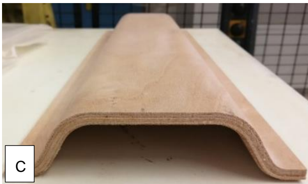
Abbildung 22: Herstellungsprozess des Hutprofil-Holzkerns. A: Einlegen der mit Klebstoff bestrichenen Furnierlagen in das Werkzeug. B: Seitenansicht des Hutprofil-Werkzeugs beim Zusammenfahren während des Pressvorgangs. C: An den Längsseiten besäumter Holzkern.
