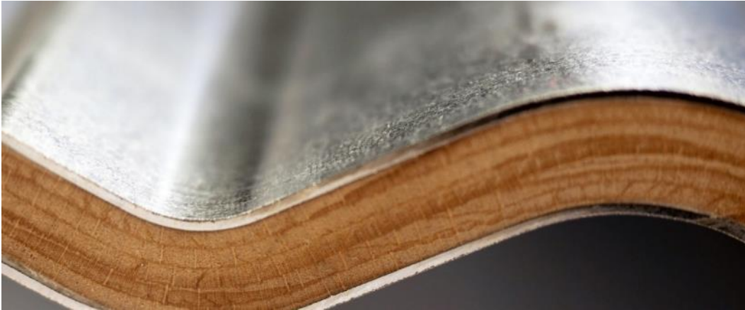
Abbildung 24: Nahaufnahme des Stringers; Furnierbasiertes Multimaterialformteil bestehend aus einem Holzkern und zwei Blechen als Außenlagen (Foto: Manuela Lingnau, Fraunhofer WKI)
