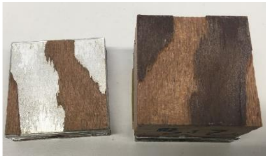
A: Probekörper 3.2, verklebt mit Klebstoff 3 (1K PU), thermische Belastung von 200 °C; Versagensart: ½ Deckfurnier, ½ Alublech
