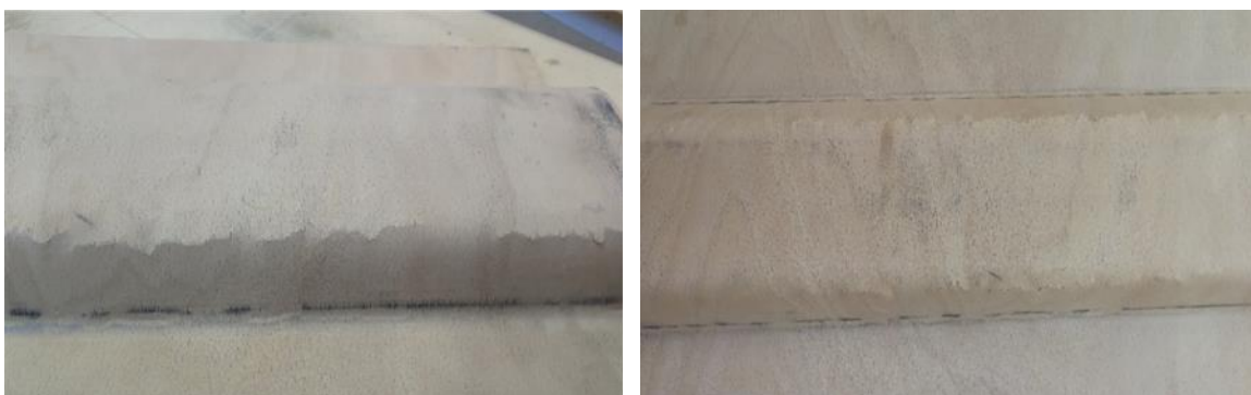
Abbildung 26: Stringer-Profil mit fünf Lagen 1,5 mm Buchenfurnier unidirektional gesperrt, an den Radien gebrochen
