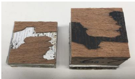
C: Probekörper 6.2, verklebt mit Klebstoff 9 (2K SE), thermische Belastung von 200 °C; Versagensart: ½ Deckfurnier, ½ Alublech
