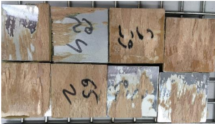
Abbildung 16: 5-lagiges, unidirektionales LVL nach Vorbehandlung: Verklebung versagt zum Joch
