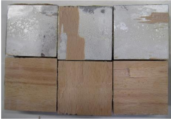
Abbildung 15: 5-lagiges, unidirektionales LVL ohne Vorbehandlung: Verklebung versagt zum Joch
