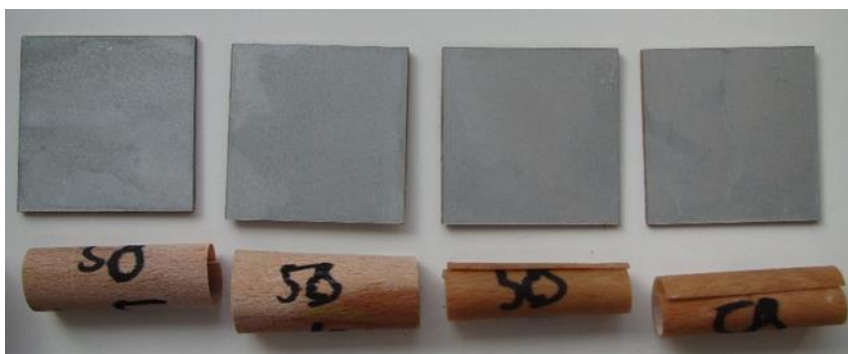
Abbildung 14: Prüfkörper mit feuerverzinktem Blech: alle Prüfkörper haben sich nach drei Tagen Kaltwasserlagerung vom Blech gelöst
