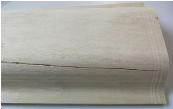
Abbildung 27: Stringer-Profil mit vier Lagen 2,0 mm Hainbuchenfurnier unidirektional in Längsrichtung, weist Risse auf
