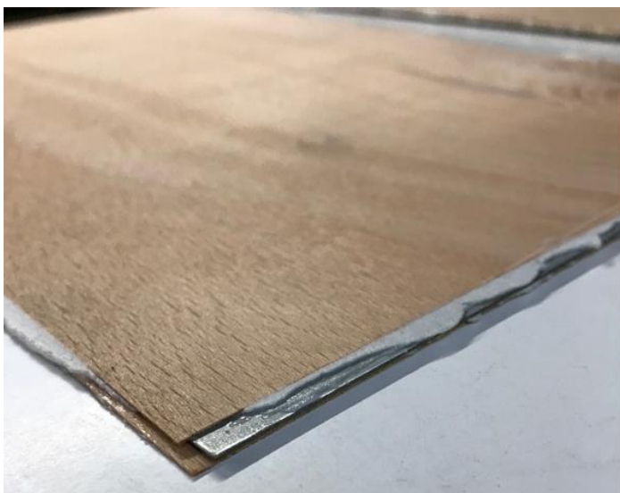
Abbildung 8: Lagenwerkstoff mit Blech als Mittellage
