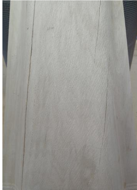
Abbildung 27: Stringer-Profil mit vier Lagen 2,0 mm Hainbuchenfurnier unidirektional in Längsrichtung, weist Risse auf
