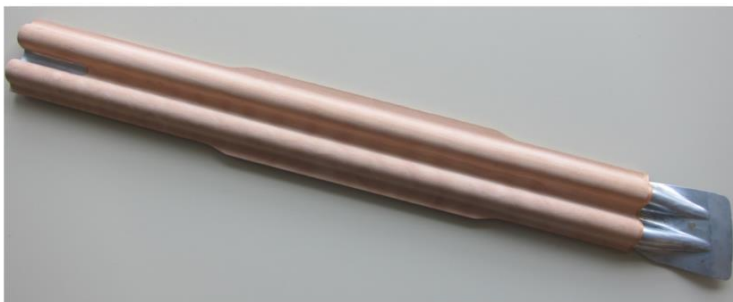
Abbildung 4: Erster Demonstrator Projekt HAMMER: Seitenverstärkungsstrebe eines Serien-PKW
