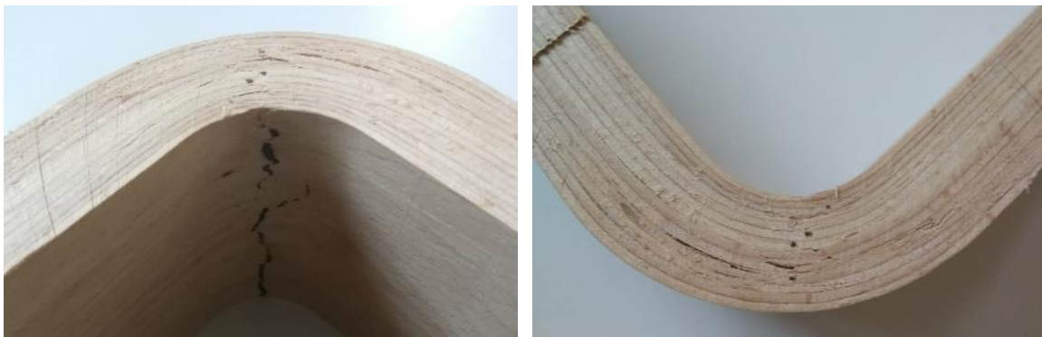
Abbildung 31: L-Profil mit gerissenen Furnierlagen nach Überverdichtung
